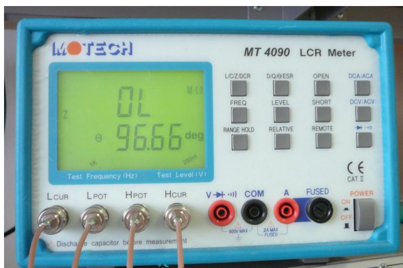
Obr. 4.7 RLC metr MOTEC MT 4090 používaný k měření impedance a fázového posunu
