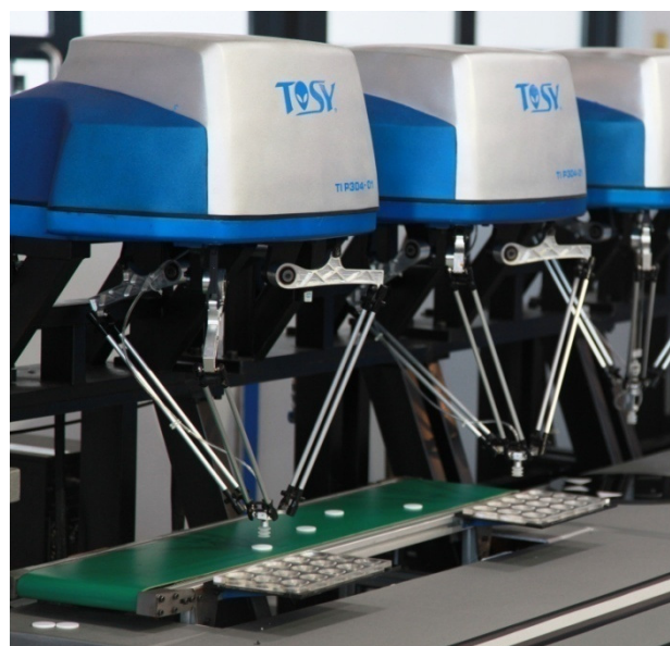
Obrázek 2: TOSY „pick and place“ robot [7]
