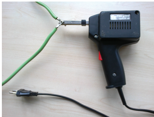
Obr. 4.14: Pájka jako generátor se zapojenou jednozávitovou cívkou
