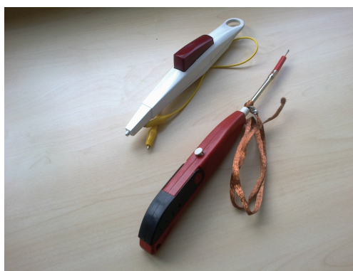
Obr. 4.5: Fotografie alternativních generátorů ESD (1) zapalovač s měničem dole, (2) piezo-zapalovač nahoře
