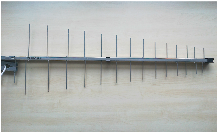
Obr. 4.20: Širokopásmová logaritmicke-periodická televizní anténa LP45F
