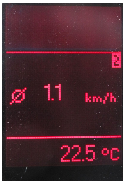
Obrázek B.10: Zobrazení průměrné rychlosti na červeném displeji s řadičem SED1560 z vozidla Volkswagen Passat B5.
