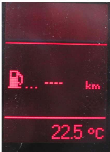
Obrázek B.7: Zobrazení dojezdu na červeném displeji s řadičem SED1560 z Volkswagen Passat B5.
