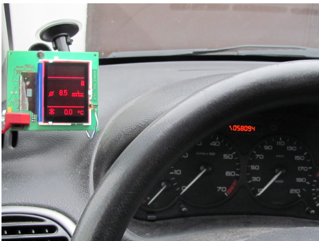
Obrázek B.17: Červený displej s řadičem SED1560 z vozidla Volkswagen Passat B5 umístěný na čelním skle vozidla Peugeot 206.
