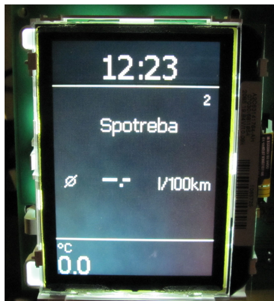
Obrázek B.2: Zobrazení průměrné spotřeby paliva na displeji v bílé variantě s řadičem SED1575 z vozidla Škoda Octavia druhé generace.
