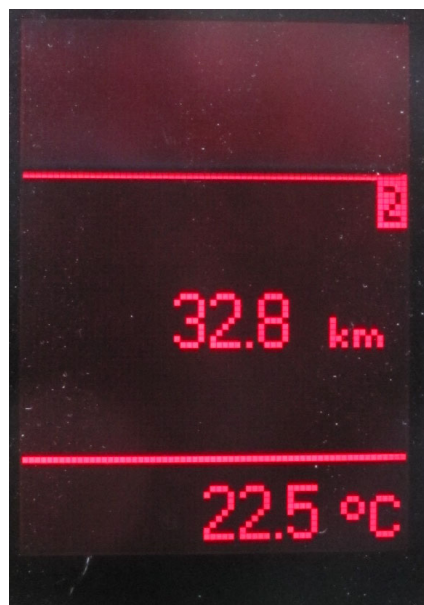
Obrázek B.8: Zobrazení ujeté vzdálenosti na červeném displeji s řadičem SED1560 z Volkswagen Passat B5.
