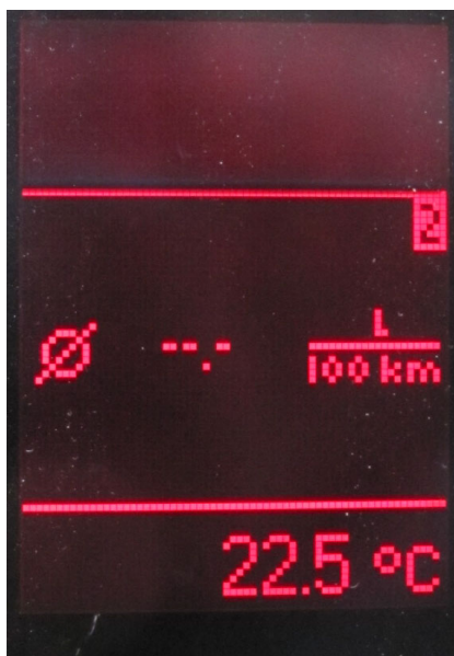
Obrázek B.9: Zobrazení průměrné spotřeby paliva na červeném displeji s řadičem SED1560 z vozidla Volkswagen Passat B5.
