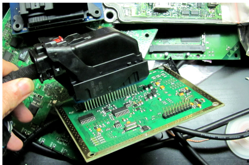
Obrázek B.16: Připojená jednotka palubního počítače na pracovním stole během oživování obvodu.
