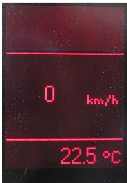
Obrázek B.5: Zobrazení rychlosti vozidla na červeném displeji s řadičem SED1560 z Volkswagen Passat B5.
