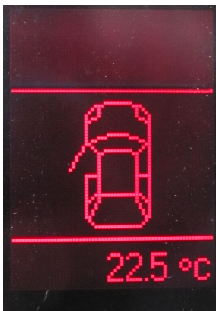
Obrázek B.6: Vizualizace stavu dveří vozidla na červeném displeji s řadičem SED1560 z Volkswagen Passat B5.
