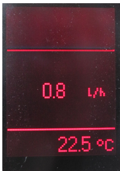
Obrázek B.4: Zobrazení okamžité spotřeby paliva na červeném displeji s řadičem SED1560 z Volkswagen Passat B5.
