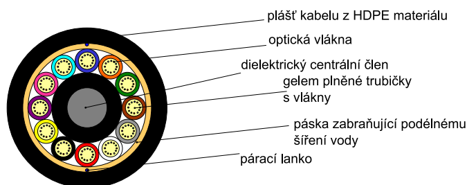
Obrázek 2.19 12-prvkový kabel MiDia Dry Core s kapacitou 144 vláken(převzato z [31])
