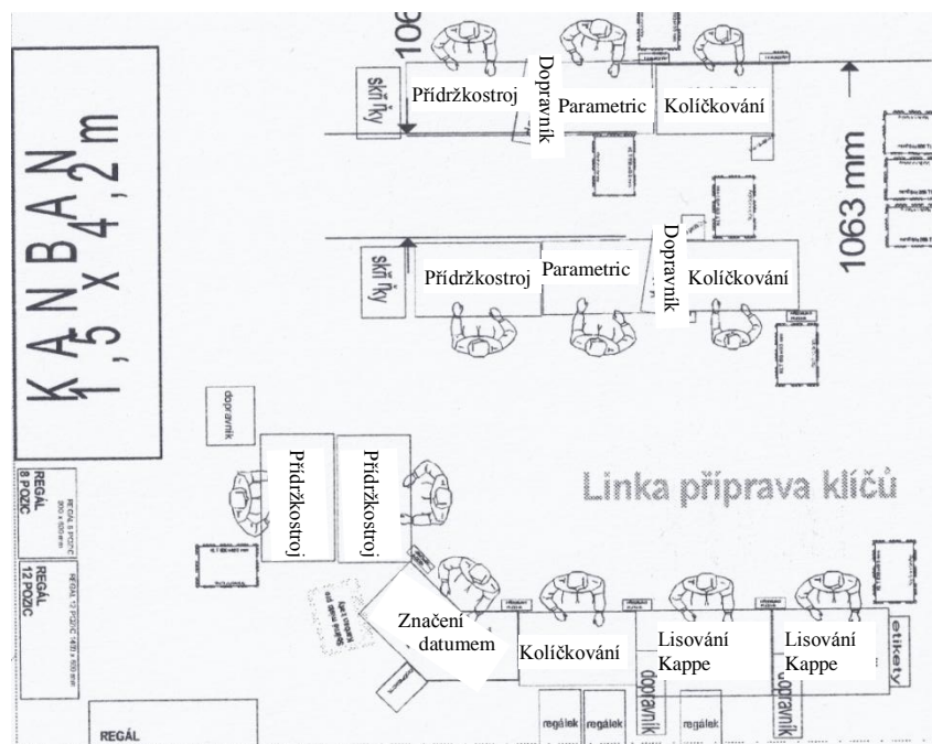
Obr. č. 12: Nové uspořádání pracoviště „U-linka“
