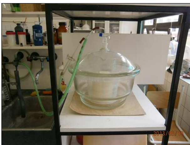
Obrázek 46 Odplynění hmoty kompozitu
