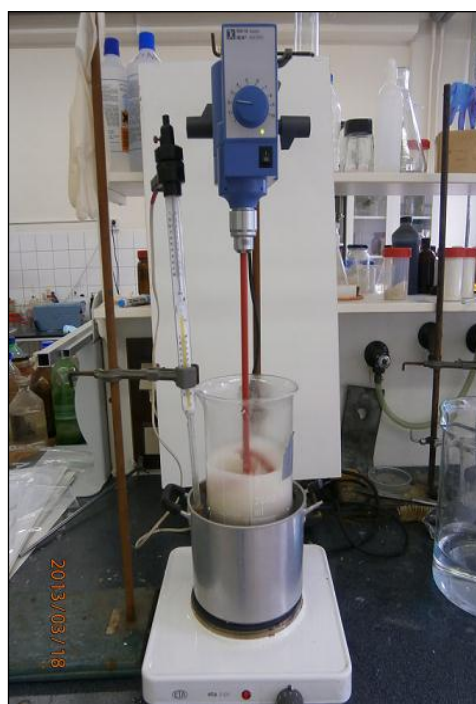
Obrázek 45 Plastifikace škrobové matrice
