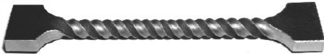
Obrázek 12 Tvar zkušební vzorku z TWIP oceli po zkoušce krutem zastudena [16].
