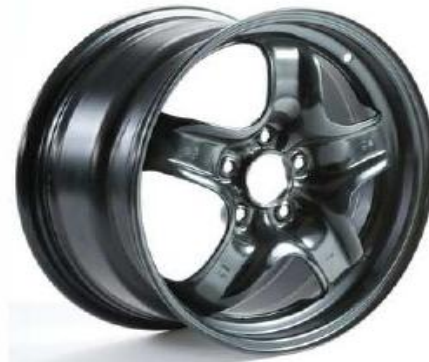
Obrázek 9 Příklad využití DP oceli na disk automobilu [8].
