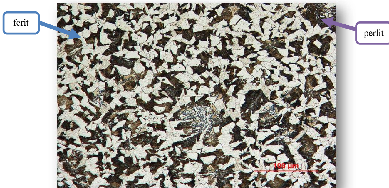
Obrázek 26 Výchozí mikrostruktura, feriticko-perlitická, SM.
