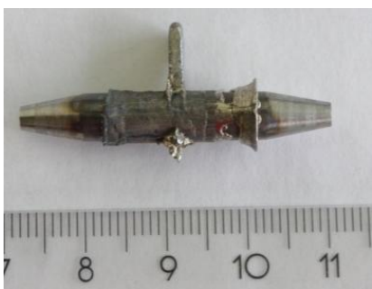
Obr. 95 K190, Detail produktu po mini-tixotomingu - 1230°C
