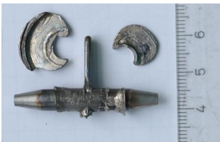
Obr. 71 K190, Detail produktu po mini-tixoformingu - 1260°C
