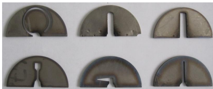
Obr. 20 Drážky pro tixofforming
