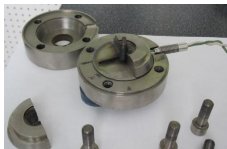
Obr. 19 Titanová forma pro tixofforming
