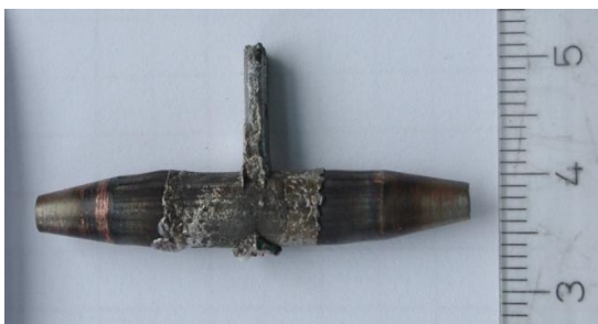
Obr. 67 CPM S30V, Detail produktu po mini-tixoformingu - 1260°C
