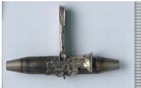
Obr. 40 CPM 15V, Detail produktu po mini-tixoformingu - 1270°C
