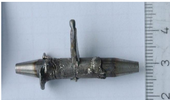
Obr. 79 K190, Detail produktu po mini-tixoforgingu - 1250°C
