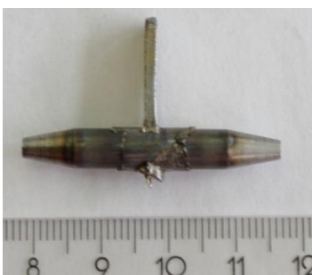
Obr. 83 K190, Detail produktu po mini-tixoformingu - 1240°C
