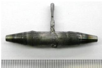
Obr. 50 CPM 15V, Detail produktu po mini-tixoformingu - 1265°C
