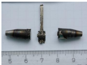
Obr. 58 CPM S30V, Detail produktu po mini-tixoforingu - 1270°C
