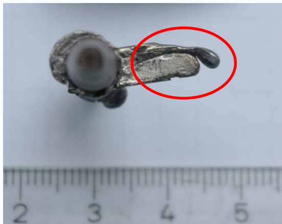
Obr. 8 Neúplné zatečení materiálu do zápustky
