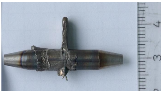
Obr. 75 K190, Detail produktu po mini-tixoforgingu - 1255°C
