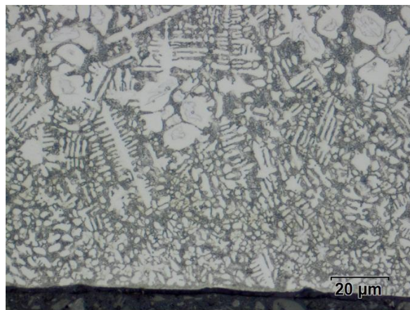
Obr. 78 K190, Struktura po mini-tixoforgingu - pozice B - 1255°C světelný mikroskop
