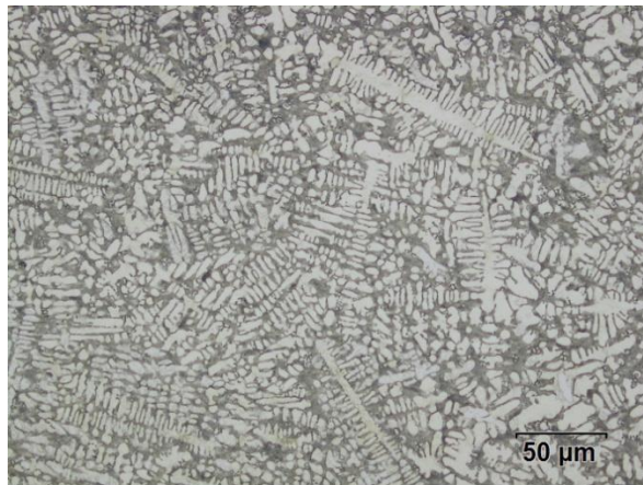
Obr. 10 Dendritická struktura po tixoformingu
