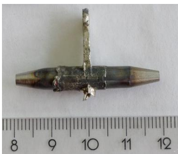
Obr. 54 CPM S30V, Detail produktu po mini-tixofomingu - 1280°C
