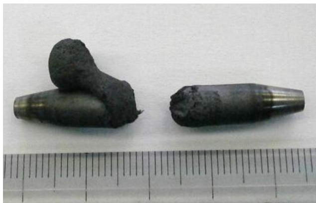
Obr. 36 CPM 15V, Detail produktu po mini-tixoformingu – 1310°C
