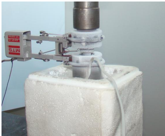
Obr. 8.4 Umístění přípravku přímo v lázni
