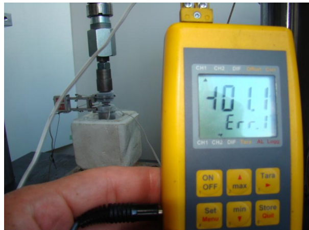
Obr. 8.5 Měření teploty během testu, +3 °C
