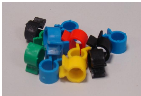
Obr. 8.8 Umístění SP vzorku před zalitím do Dentakrylu
