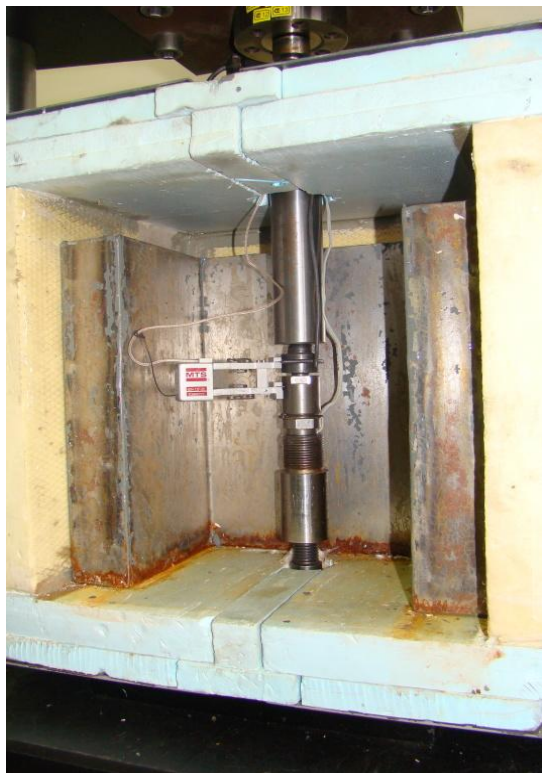
Obr. 8.1 Kryogenní komora do -130\text{ }^{\circ}\text{C}
