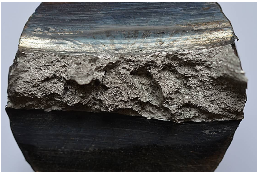
Obr. 10.12 Vzhled lomové plochy odlitků zkušebních tyčí Ø 50 mm -navrhovaná ocel a) litý stav b) tepelně zpracovaný stav
