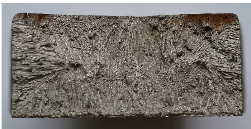
Obr. 10.14 Lomová plocha třmenu tlukadla - litý stav oceli 42 2921
