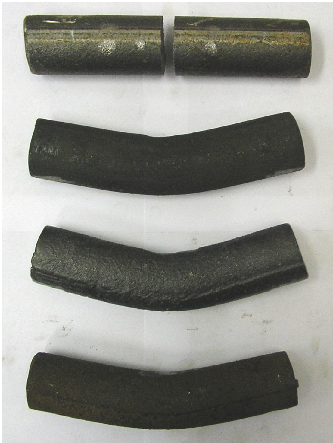
Obr. 10.10 Porovnání deformací zkušebních tyčí Ø 40mm ze shora: 42 2921 litá, 42 2921 tepelně zpracovaná, navrhovaná ocel litá navrhovaná ocel tepelně zpracovaná
