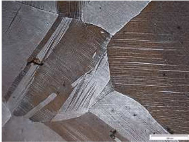
Obr. 4.4 Martenzit v austenitických zrnech - ocel s 0,9% C a 13% Mn, zvětšeno 500x [5]
