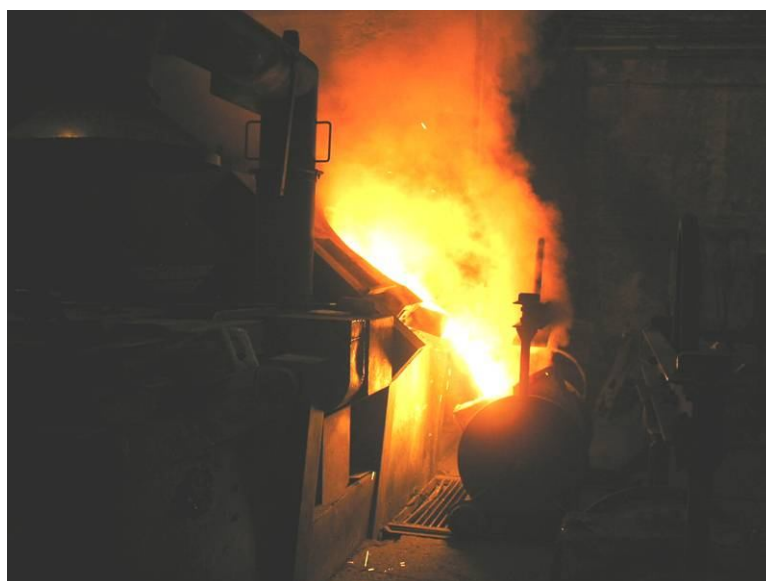
Obr. 7.1 Zásaditá elektrická oblouková pec a pánev - odlévání oceli 42 2921
