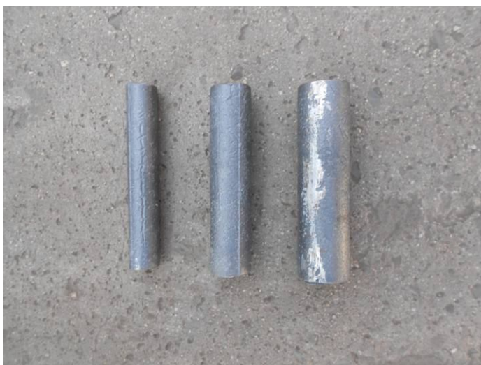
Obr. 10.1 Tvar zkušebních tyčí - Ø30,40,50 mm
