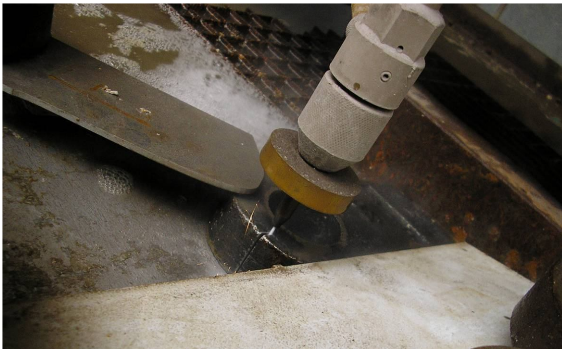
Obr. 10.16 Odebírání vzorku z třmenu tlukadla - řezání vodním paprskem
