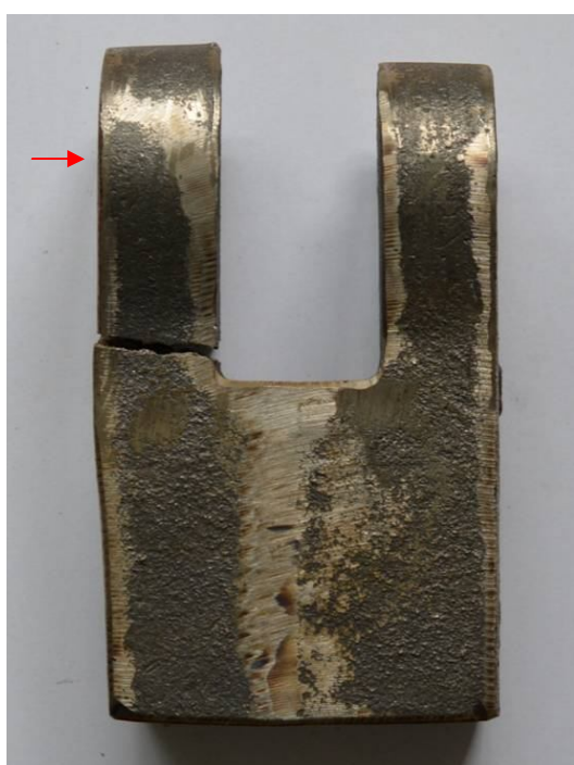
a) b) Obr. 10.13 Porovnání deformace tlukadel z oceli 42 2921 a) litý stav b) tepelně zpracovaný stav
