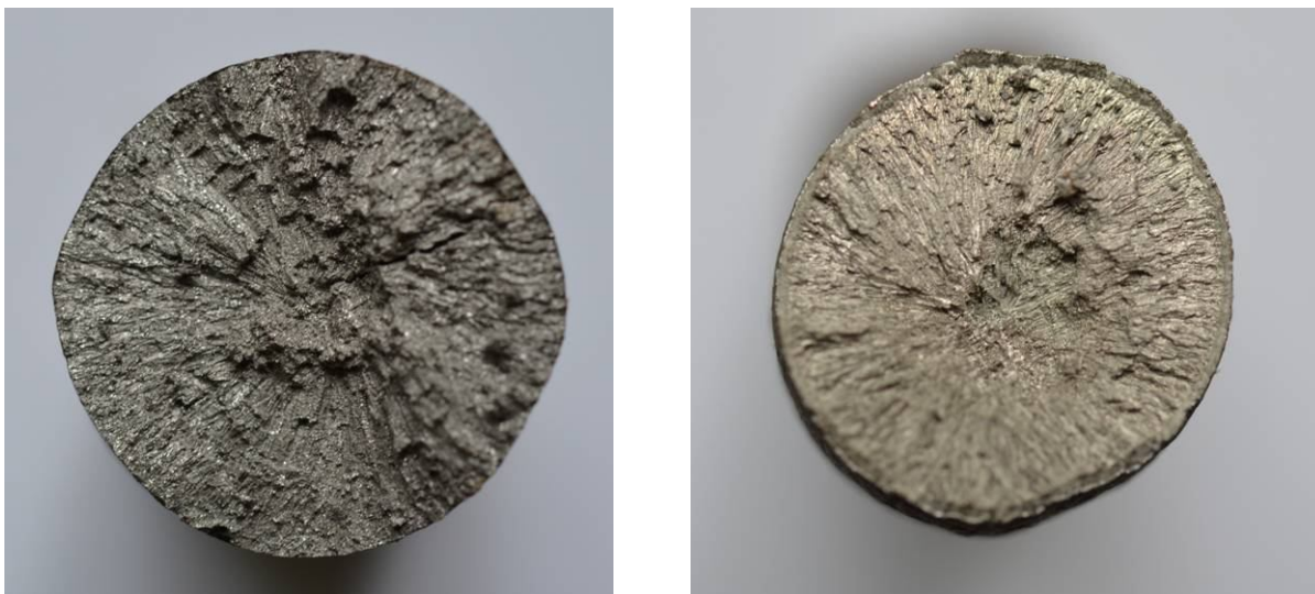
Obr. 10.5 Vzhled lomové plochy odlitků zkušebních tyčí Ø 30 mm -ocel 42 2921 a)litý stav b)tepelně zpracovaný stav
