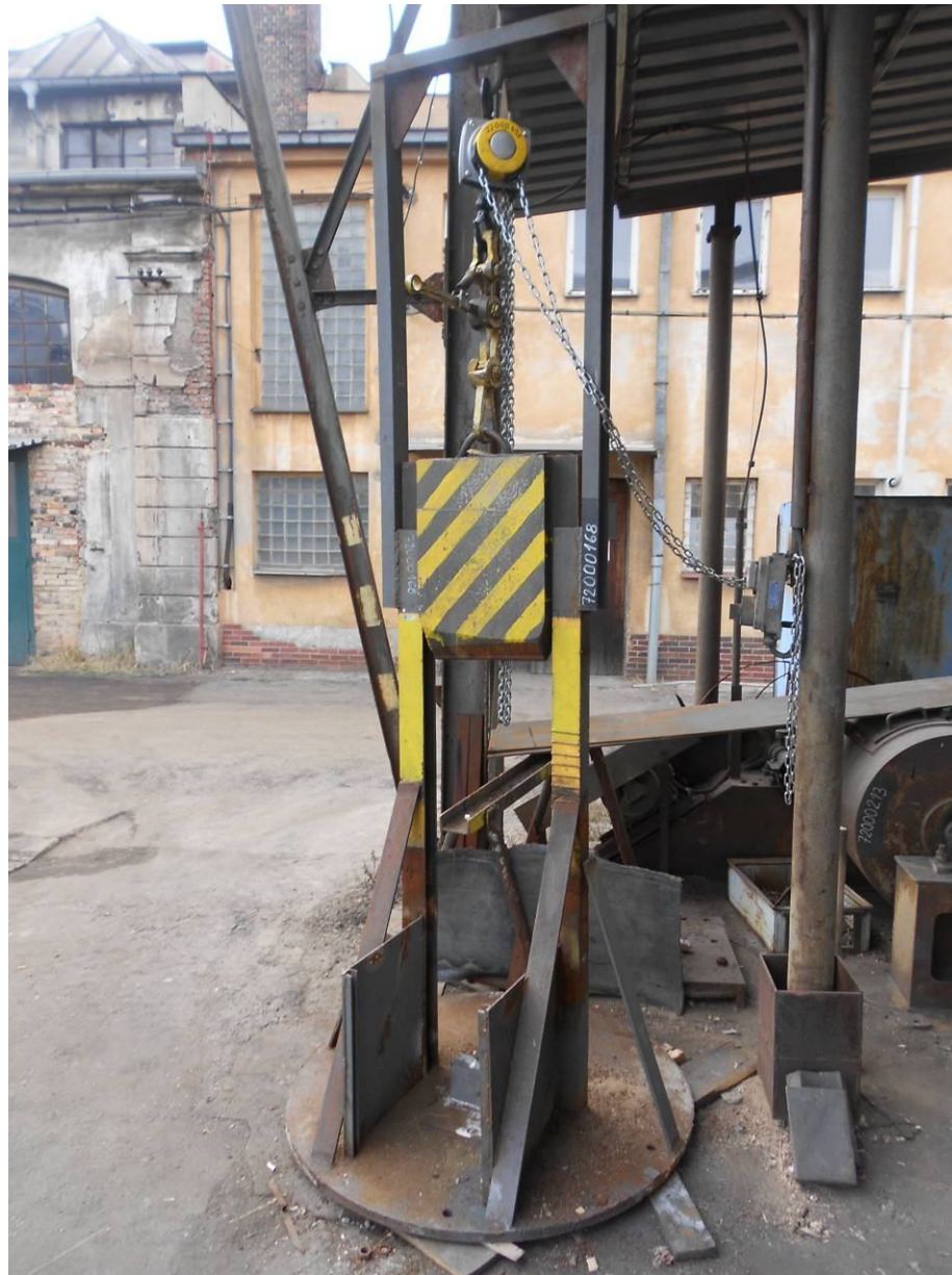
Obr. 10.3 Zkušební padostroj - hmotnost beranu 150 kg, max. pracovní zdvih 180 cm
