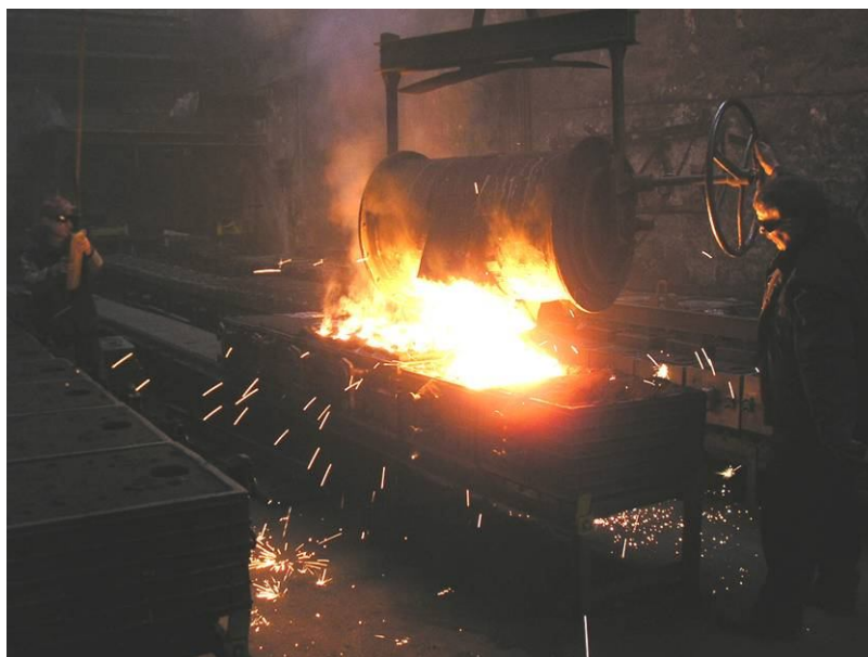
Obr. 8.1 Odlévání oceli 42 2921 do netrvalé neutrální formy
