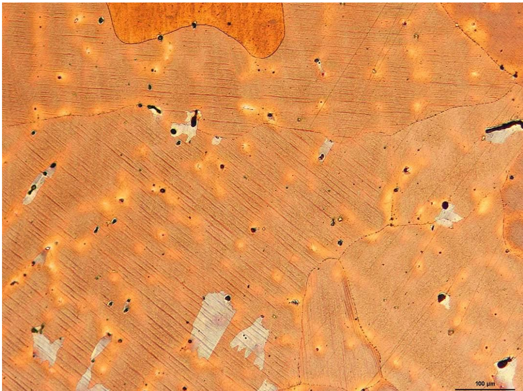
Obr. 10.39 Navrhovaná ocel - stav po tepelném zpracování a) zvětšeno 50x/nital b) zvětšeno 100x/nital Deformačně indukovaný martenzit, hranice austenitického zrna
