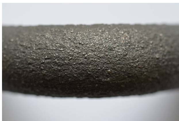
Obr. 10.5 Vzhled lomové plochy odlitků zkušebních tyčí Ø 30 mm -ocel 42 2921 a)litý stav b)tepelně zpracovaný stav
