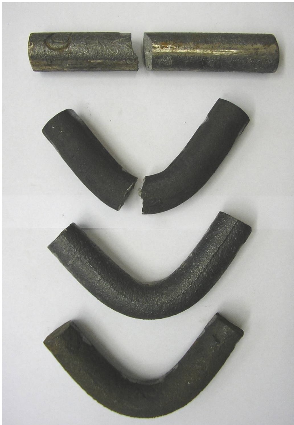
Obr. 10.7 Porovnání deformací zkušebních tyčí Ø 30mm ze shora: 42 2921 litá, 42 2921 tepelně zpracovaná, navrhovaná ocel litá navrhovaná ocel tepelně zpracovaná
