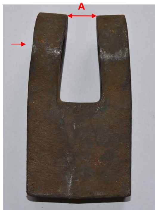
a) b) Obr. 10.13 Porovnání deformace tlukadel z oceli 42 2921 a) litý stav b) tepelně zpracovaný stav
