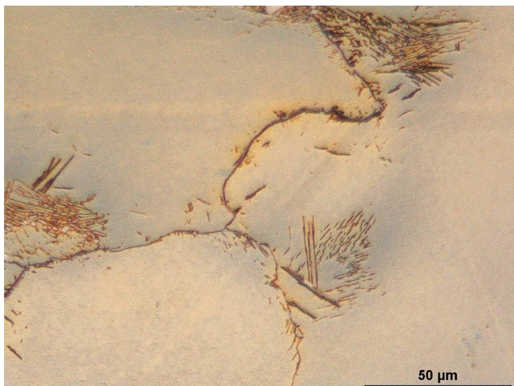
Obr. 10.28 Ocel 42 2921 - stav po tepelném zpracování - detail struktury, 500x/nital a) hranice austenitických zrn b) struktura uvnitř austenitických zrn Nerozpuštěné karbidy na hranicích a uvnitř austenitických zrn
