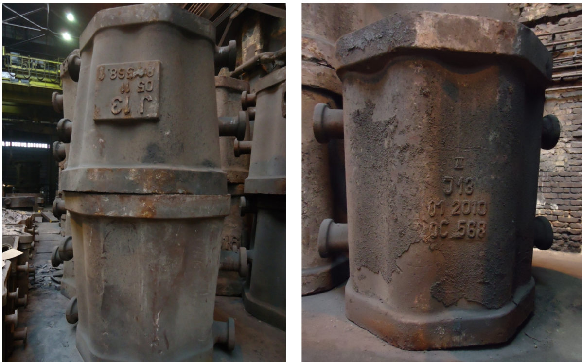
Obr. 55 – srovnání nové kokily formátu I 13B (vlevo) a původní I 13 (vpravo)
