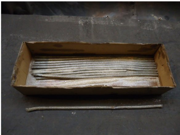
Obr. 25 – těsnění v místě dotyku hlavy s kokilou (Dikaflex) + licí prášek a exotermní zásyp hlavy
