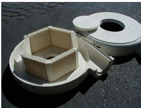
Obr. 29 – schéma filtračního karuselu a nutné speciálně upravené licí desky
