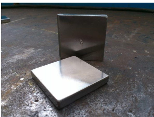
Obr. 22: Zkušební vzorek č. 8 z oceli ČSN 17 255
