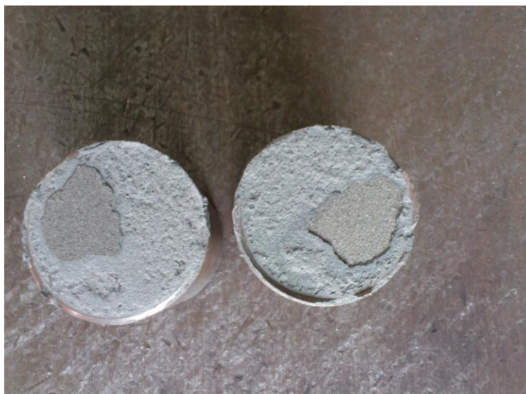
Obr. 42: Porušení povlaku NiTi (vzorek č. 2) na rozhraní mezi nastříkaným povlakem a podkladovým materiálem
