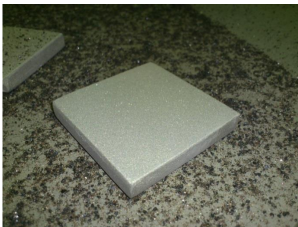
Obr. 23: Vzorek po otryskání při tlaku 0,7 MPa
