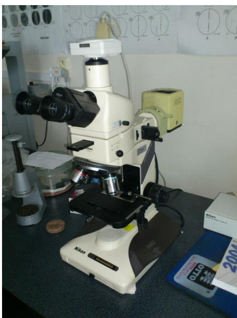
Obr. 26: Optický mikroskop NIKON OPTIPHOT-100 s digitální kamerou
