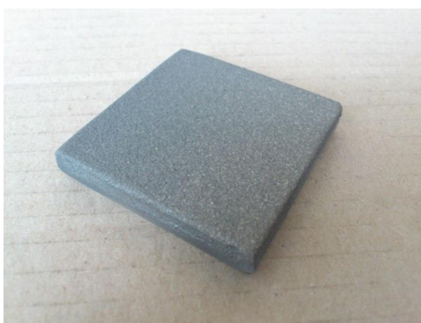
Obr. 24: Povlak NiCr vytvořený na vzorku
