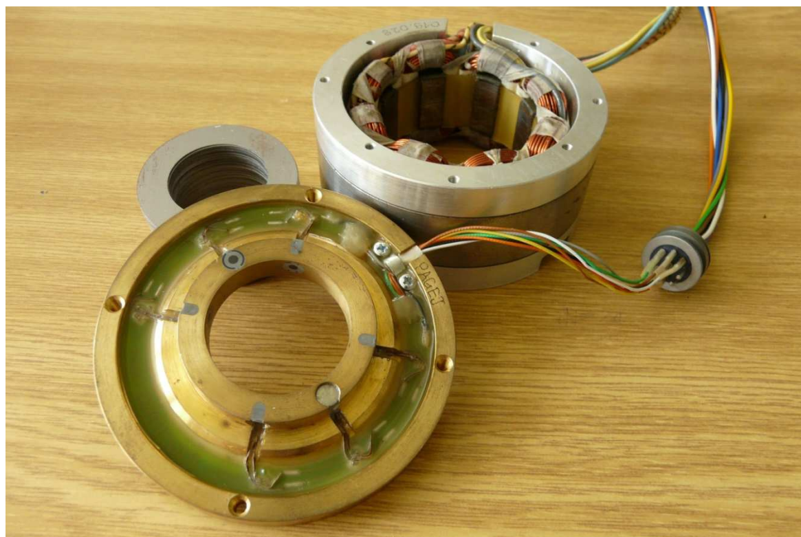
Obr. 5.8 – Magnetické ložisko Mecos s rotorovými plechy a držákem snímačů
