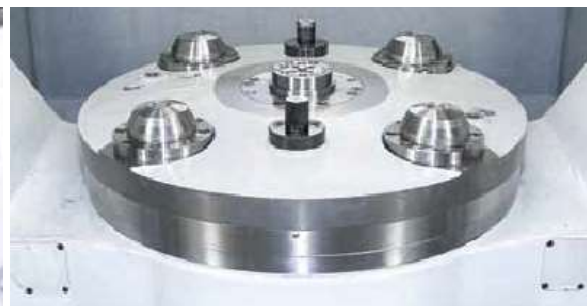
Obr. 3.4 Stůl pro paletový systém [6]
