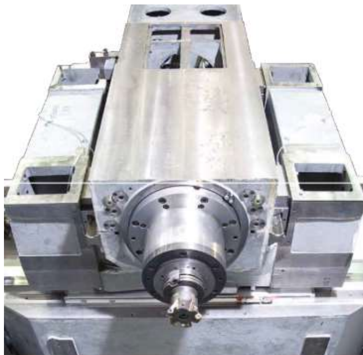
Obr. 3.12 Vřeteník stroje MCU 630 I61
