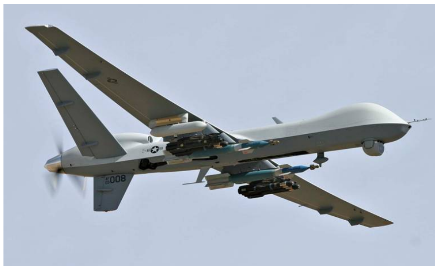
Obr. 11: MQ-9 Reaper vyzbrojený střelami AGM-114 Hellfire a dvěma laserem naváděnými bombami. [19]
