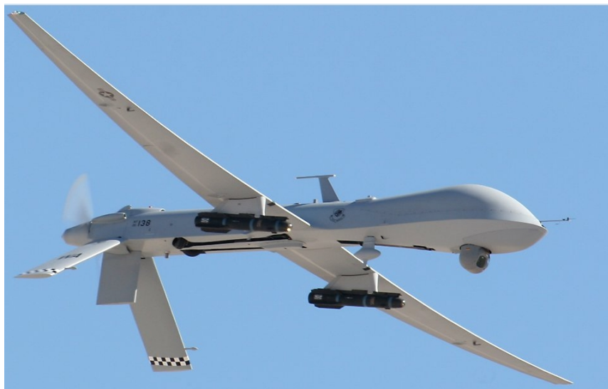
Obr. 10: MQ-1 Predator vyzbrojený dvěma střelami AGM-114 Hellfire. [18]
