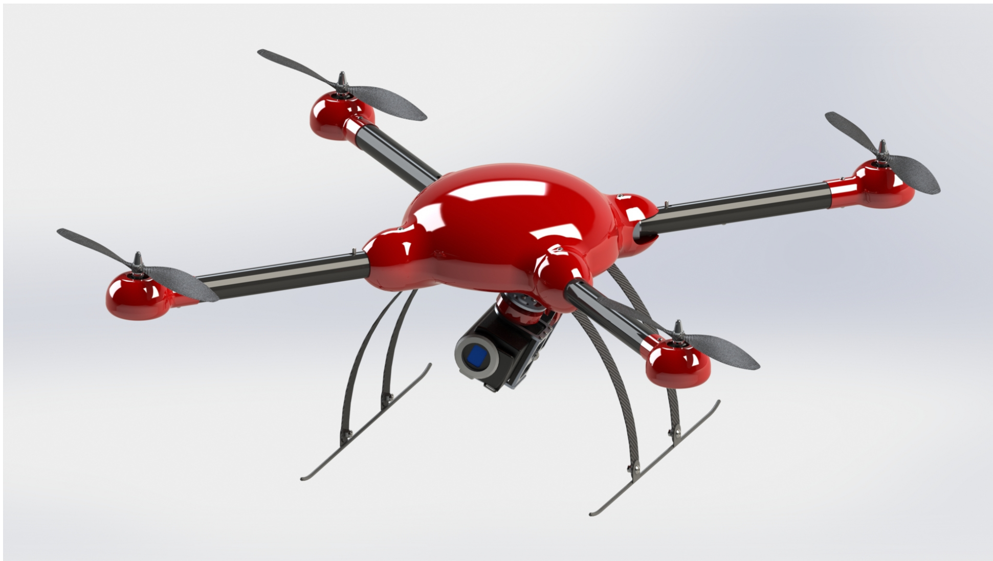
Obr. 12: Pohled na sestavu kvadrokoptery s kamerou v poloze maximálního naklonění.
