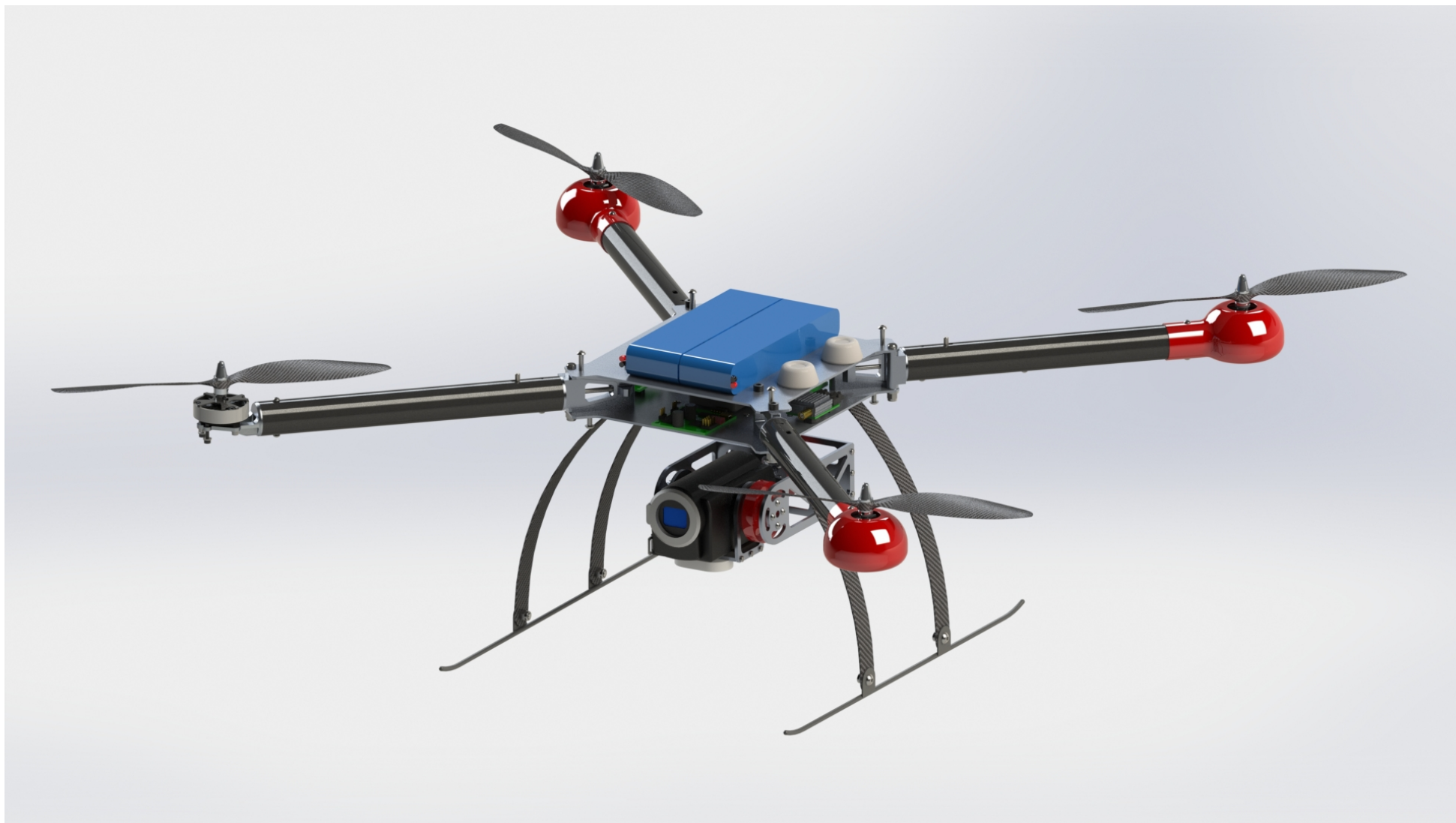
Obr. 14: Pohled na sestavu kvadrokoptery s odejmutou kapotáží středové části a s odejmutou kapotáží jednoho z motorů.
