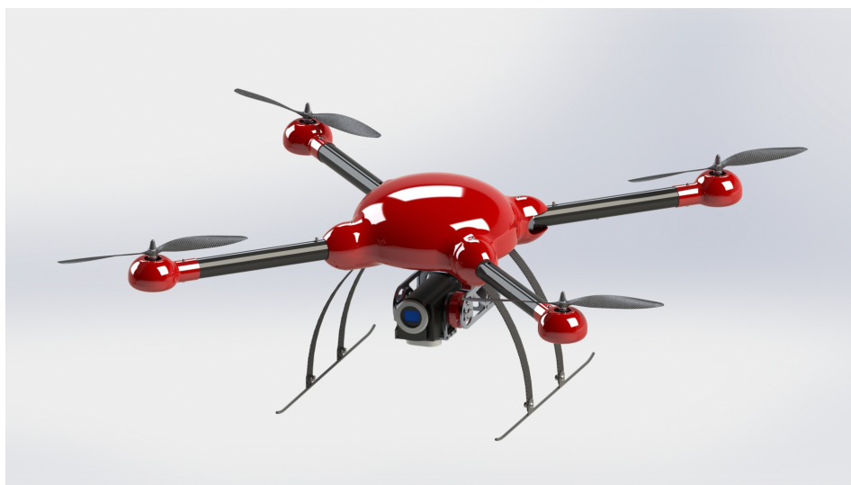
Obr. 44: Pohled na navrženou kvadrokopteru s podvěšeným gimbalem.
