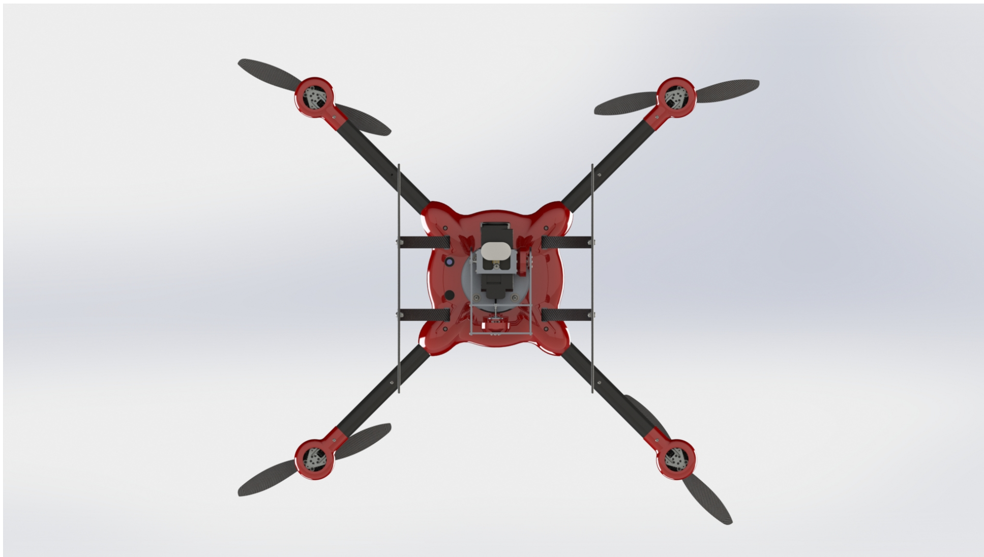
Obr. 5: Dolní pohled na sestavu kvadrokoptery. V levé části středového modulu kvadrokoptery jsou patrná čidla pro automatické přistání.
