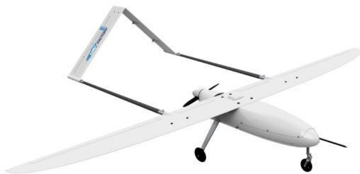
Obr. 4: Penguin B s tlačným uspořádáním pohonné jednotky a patrnou pitot-statickou trubicí. [13]
