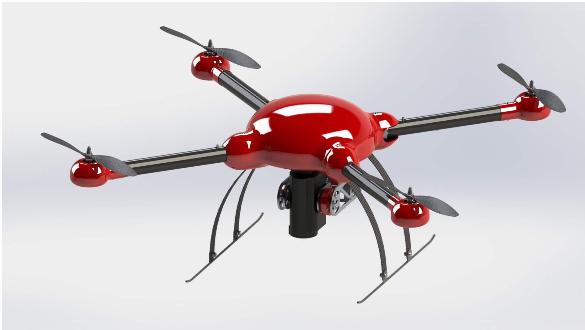
Obr. 11: Pohled na sestavu kvadrokoptery s kamerou v poloze maximálního naklonění.
