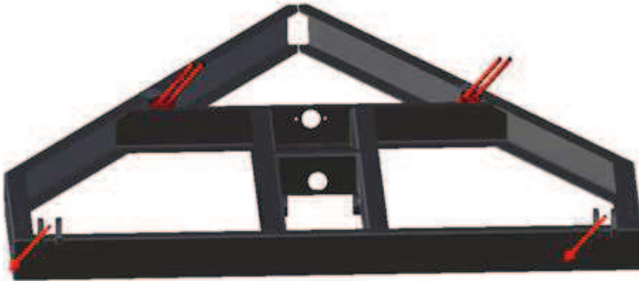
Obrázek 31: Zatížení rámu při brzdění v oblouku
