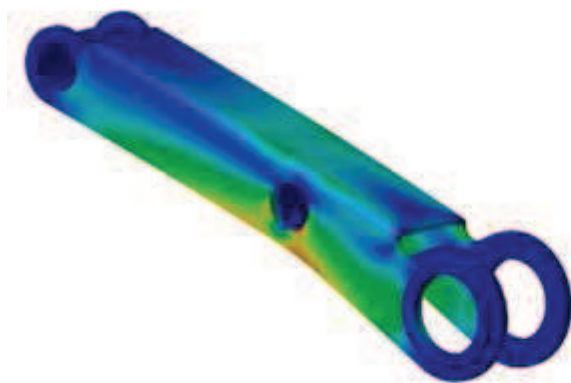
Obrázek 41: Průběh napětí ve vzpěře
