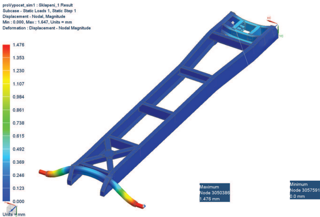
Obr. 46 Průhyb rámu při sklápění
