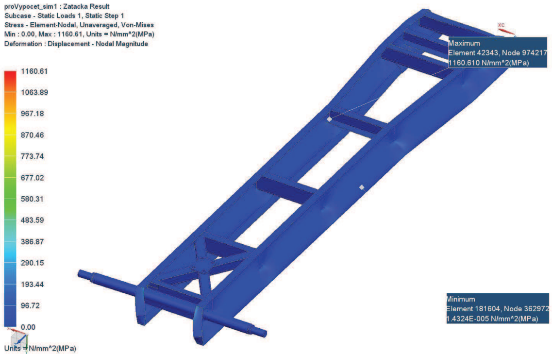
Obr. 43 Redukované napětí pro namáhání rámu při zpomalení v oblouku
