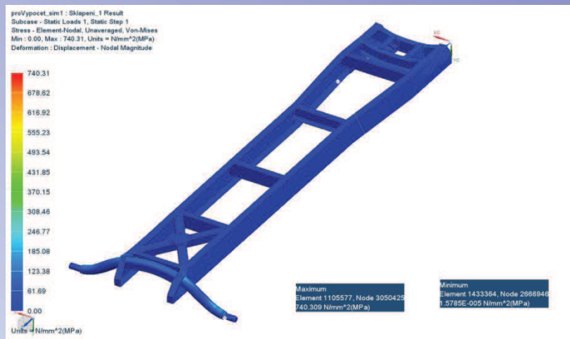
Redukované napětí pro namáhání rámu při sklápění
