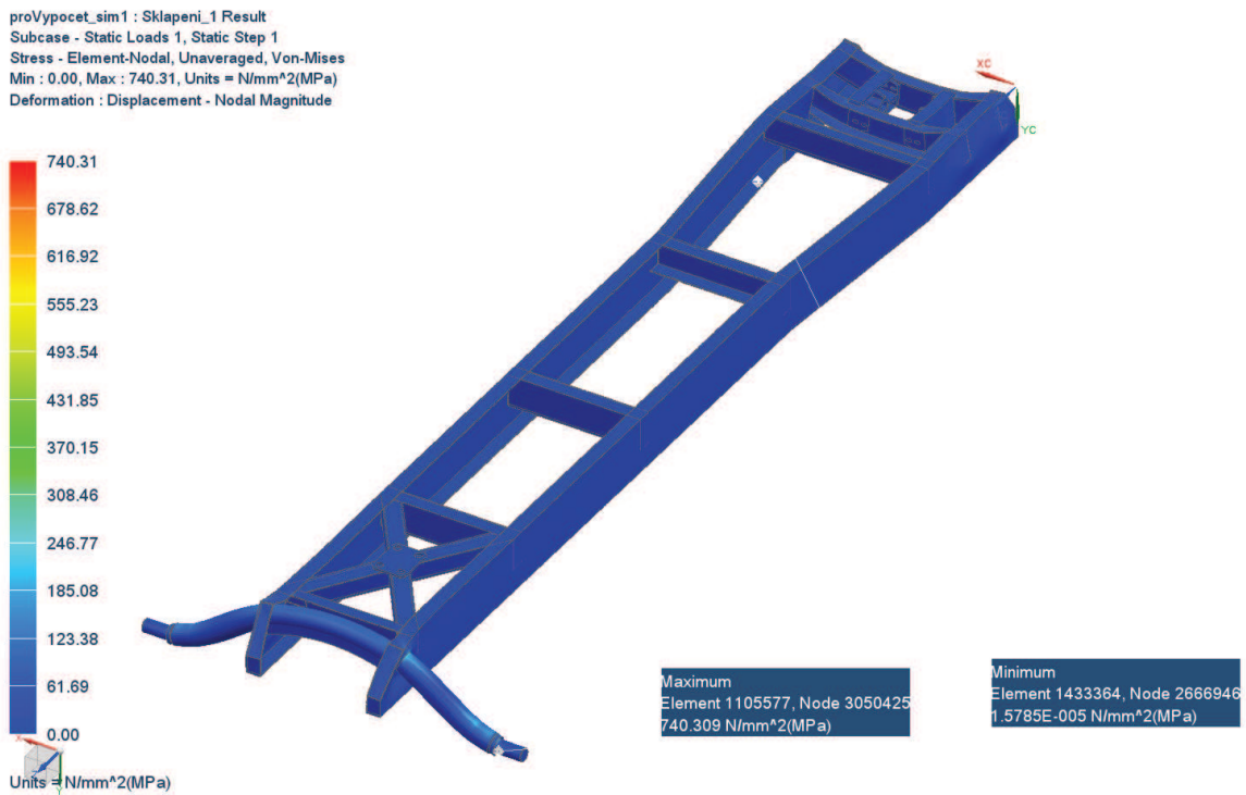
Obr. 44 Redukované napětí pro namáhání rámu při sklápění
