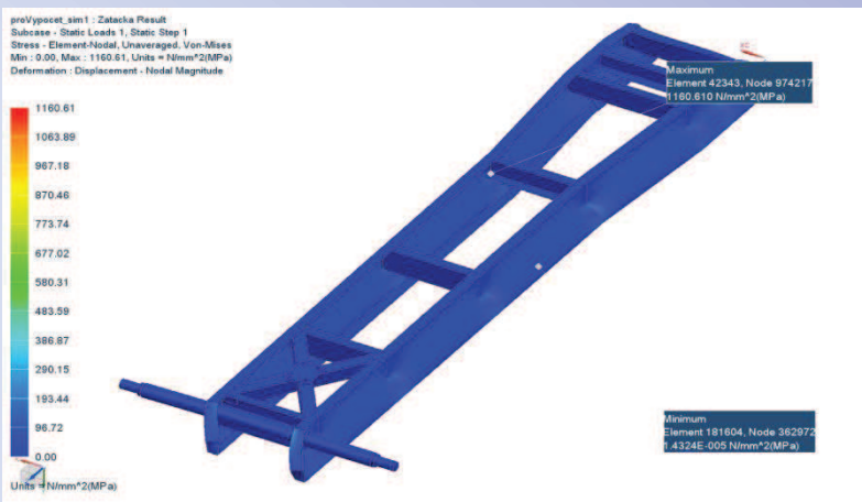
Redukované napětí pro namáhání rámu při zpomalení v oblouku
