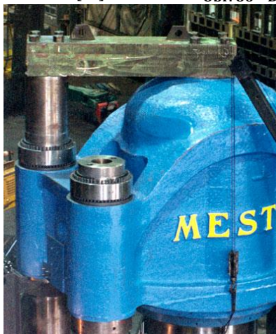
Obr. 87 - Použití matice na lisu [19]
