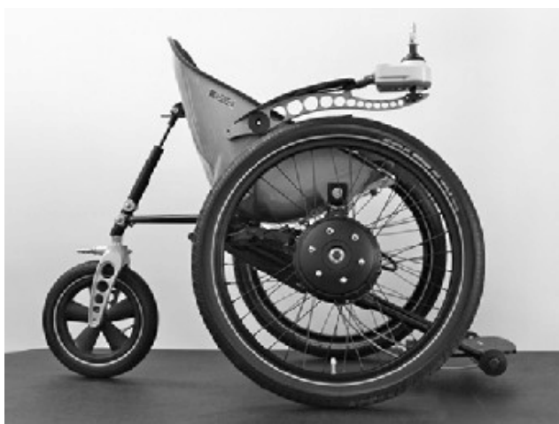
Obrázek 6.2: Ukázka hub motoru v drátovém ráfku [33]
