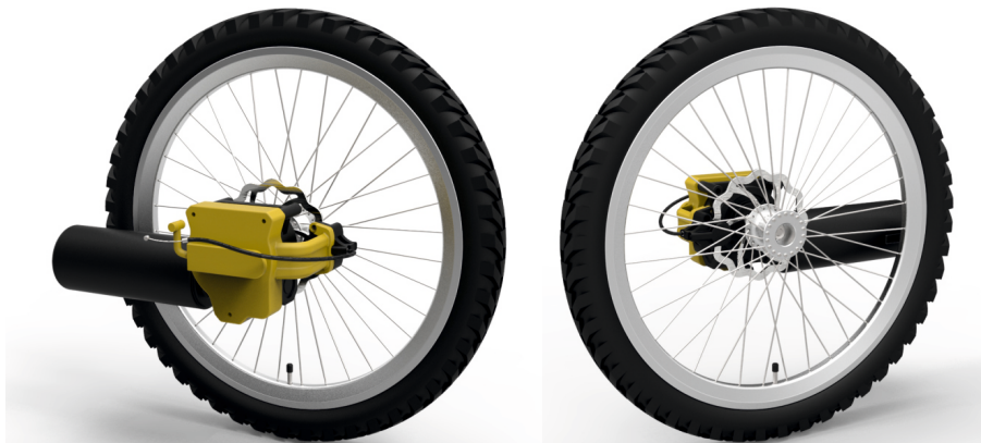
Obrázek 7.3: Pohled na podsestavu kola s motorem, redukcí a kotoučovou brzdou
