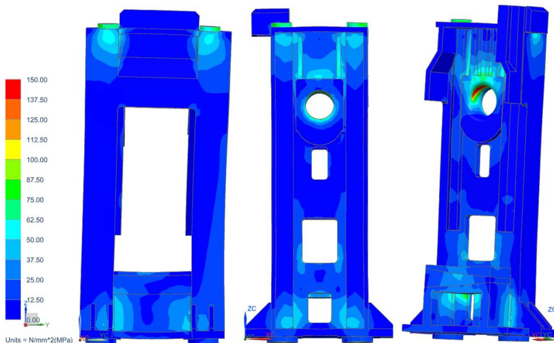
Obr. 26– Výsledky MKP excentrického zatížení varianty I.
