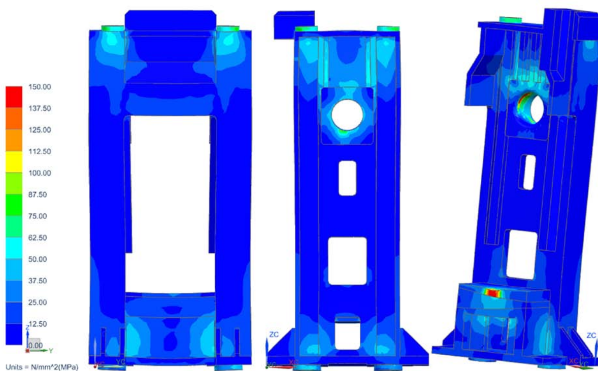
Obr. 28– Výsledky MKP centrické zatížení varianty II.
