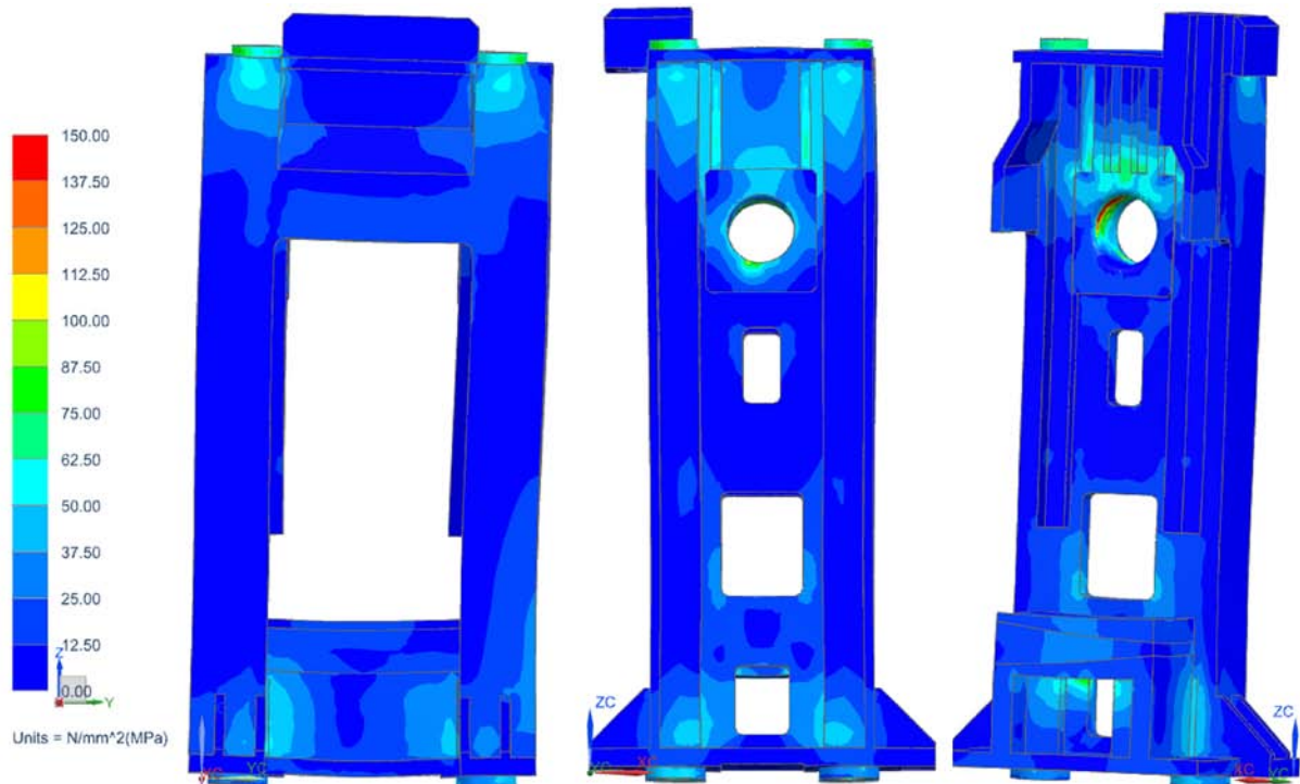
Obr. 29 – Výsledky MKP excentrické zatížení varianty II.
