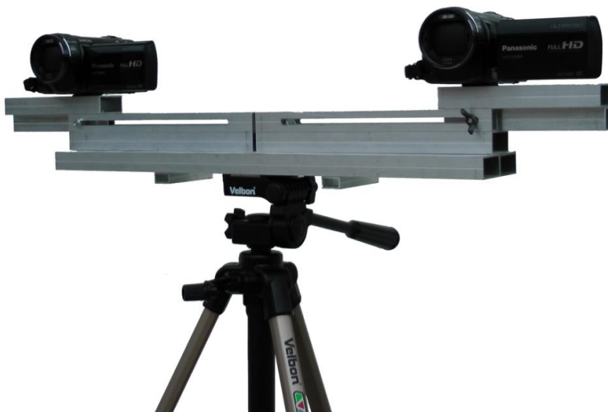
Obrázek 10: Fotografie zhotoveného stereoskopického stativu
