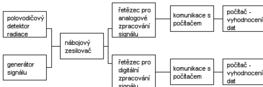
Obrázek 2.1.1 Blokové schéma konceptu obvodu
