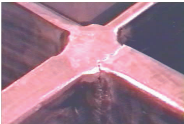
Obr.: 29 – Porušení svaru u koše V/21 [30]
