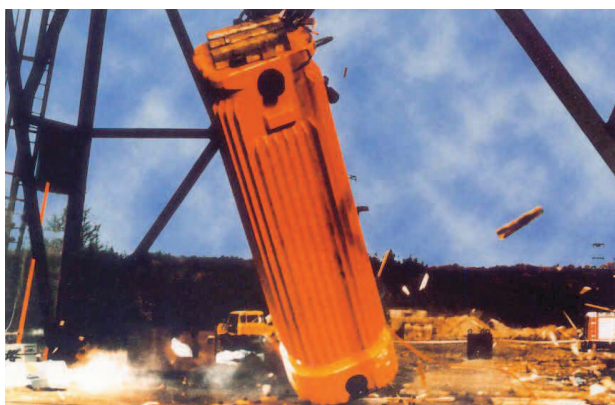
Obr.: 36 - Pádová zkouška [13]
