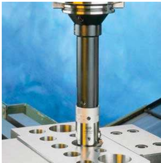
obr.: 4-8 vyvrtávací hlava dokončující [30]
