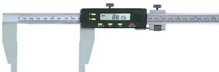
obr.: 4-13 posuvné digitální měřítko - dolní čelisti [35]
