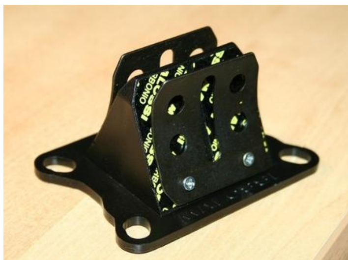
Obr. 13 Membránové sání – klapa [W5]
