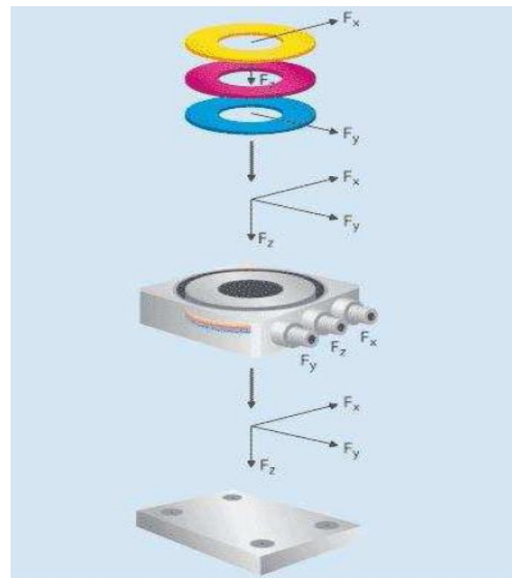
Obr. 2.2.4-1 Princip piezoelektrického dynamometru-dle [35]
