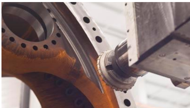
Obr. 3.2.1.1 – Čelní frézování náboje rotoru VE [37]
