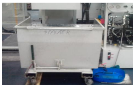
Obr. 5.2.2-2 Kontejner s dvojitým dnem
