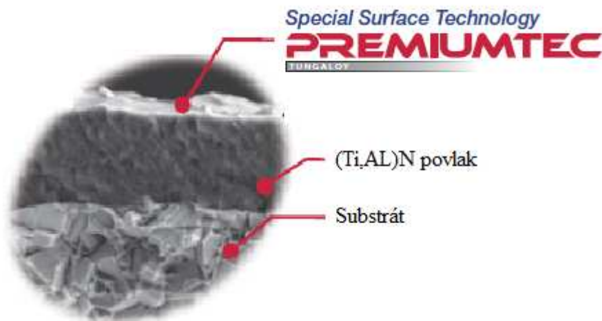
Obrázek 2.3. Povlak (Ti, Al)N s PREMIUMTEC vrstvou od společnosti Tungaloy [28]
