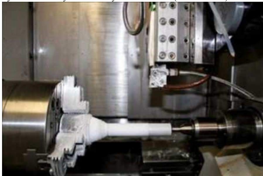
Obrázek 4.14. Kryogenní chlazení kysličníkem uhličitým [19]
