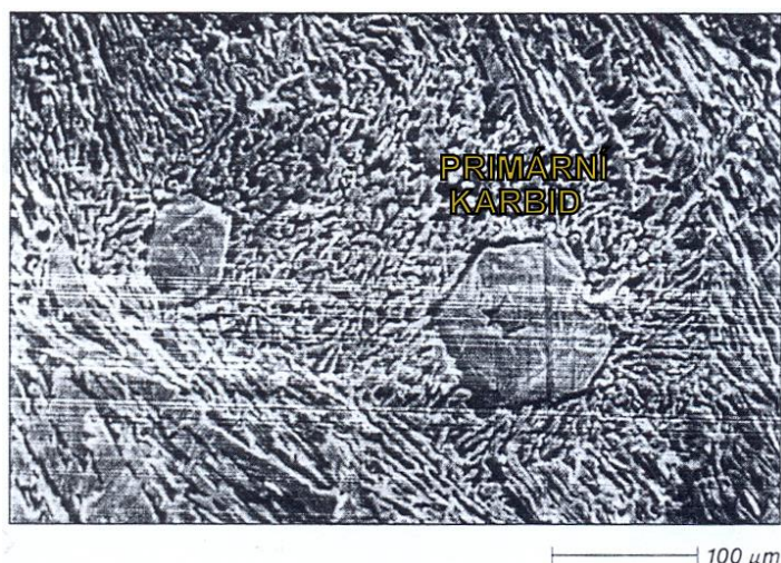
Obr. 3.10: Hrubý primární karbid chromu v nadeutektické litině obsahující 28,5 % chromu a 4,2% uhlíku; 160:1 [9]
