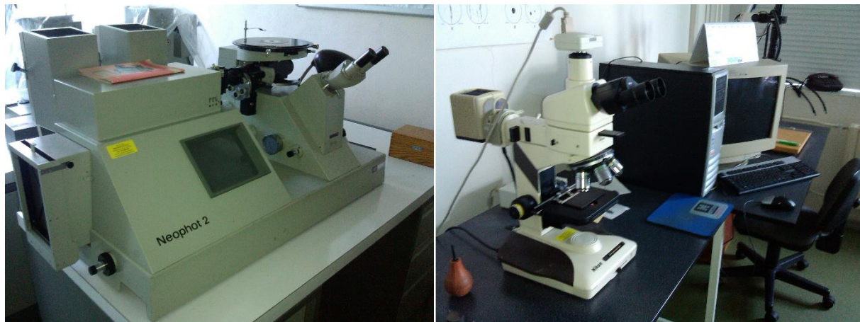
Obr. 4.1: Vlevo: Optický mikroskop Neophot 2, vpravo: Optický mikroskop NIKON 100s Optiphot
