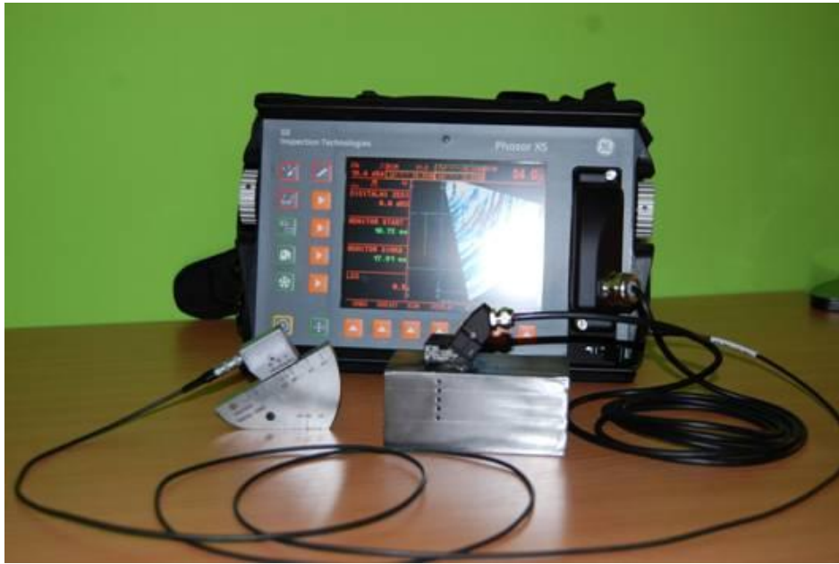
Obr. 3-19 Ultrazvukový přístroj se sondou[18]
