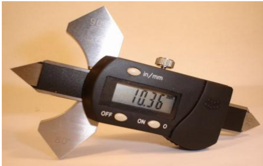
Obr. 3-18 Digitální posuvné měřítko pro koutové svary [17]
