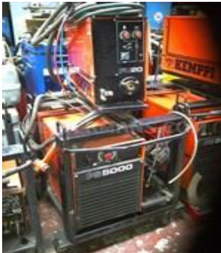
Obr. 3-21 Svařovací zařízení KEMPPPI PS 5000 [20] (WPS TS-1/13)
