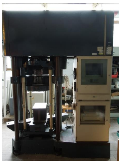
Obr. 32 Univerzální tahový stroj DMG s maximální tahovou silou 500 kN
