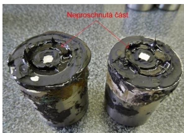
Obr. 49 Vzorek pro zjištění meze pevnosti v tahu s vyznačenou nezpolymerizovanou oblastí
