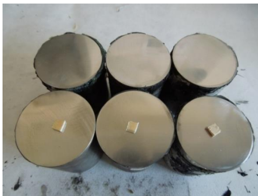
Obr. 37 Vzorky pro měření pevnosti v tahu s protikusy ( Ra\ 1,12\ \mu m )
