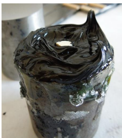
Obr. 38 Vzorek s naneseným lepidlem bezprostředně před slepením
