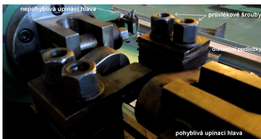
Obr. 34 Uložení vzorku pro únavovou zkoušku ohybem
