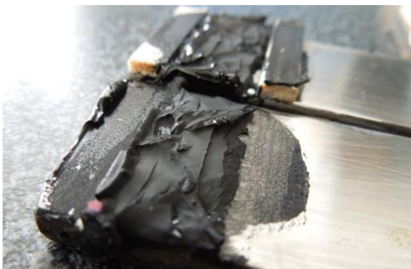
Obr. 56 Ideálně proschlý vzorek po zkoušce ve smyku tahem
