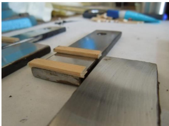
Obr. 40 Vzorek s protikusem pro měření pevnosti ve smyku o tloušťce lepeného spoje 2 mm (Ra 1,12 μm)
