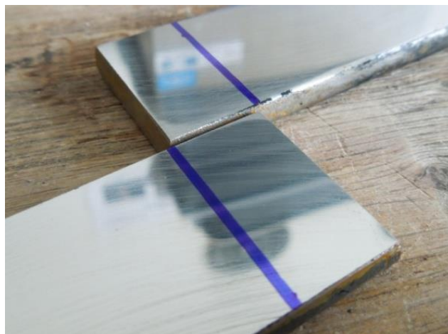
Obr. 44 Připravené vzorky pro zkoušku ve smyku s vyznačenou plochou o velikosti 300 mm 2
