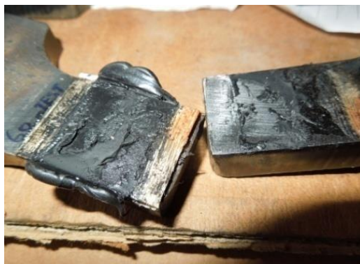
Obr. 61 Spoj po provedené cyklické zkoušce v ohybu a zjištěné pevnosti
