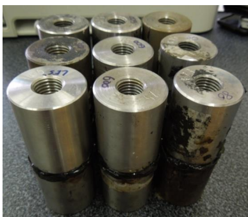
Obr. 39 Slepěné vzorky lepidlem Terostat 9220 a připravené ke zkoušce v tahu
