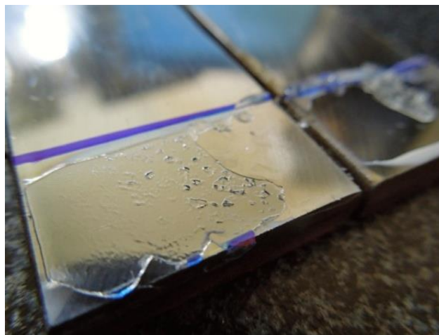
Obr. 63 Lomová plocha po provedení zkoušky pevnosti ve smyku
