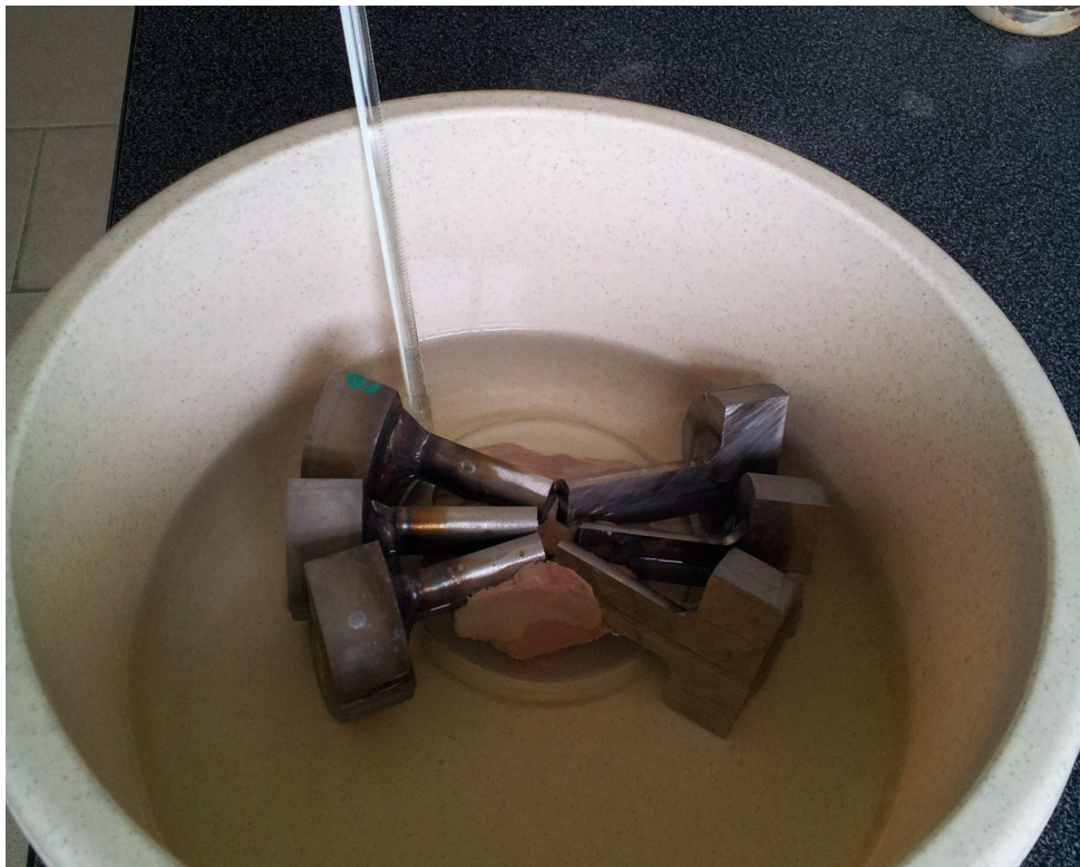
Obr.25 - Moření vzorků ve vlastní lázni s Inhibitorem P29
