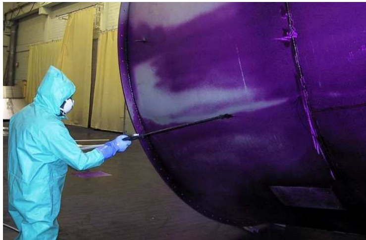
Obr.1 - Moření postříkem s přidáním barviva do mořícího gelu [I]
