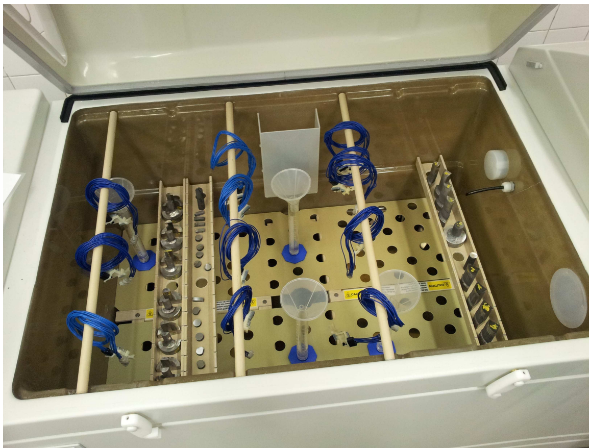
Obr.27 - Umístění vzorků v korozní komoře
