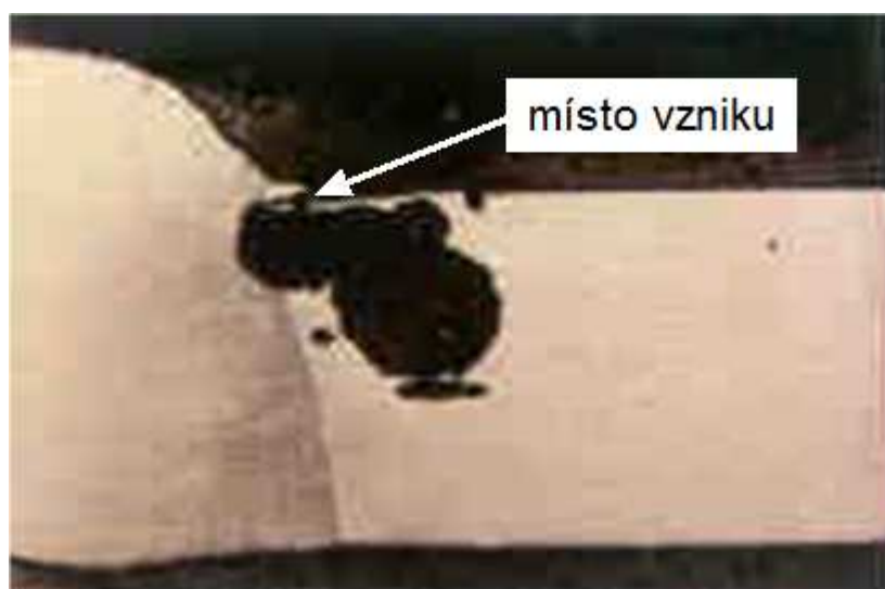
Obr.12 - Štěrbinová koroze vzniká pro nečistotu svaru [V]
