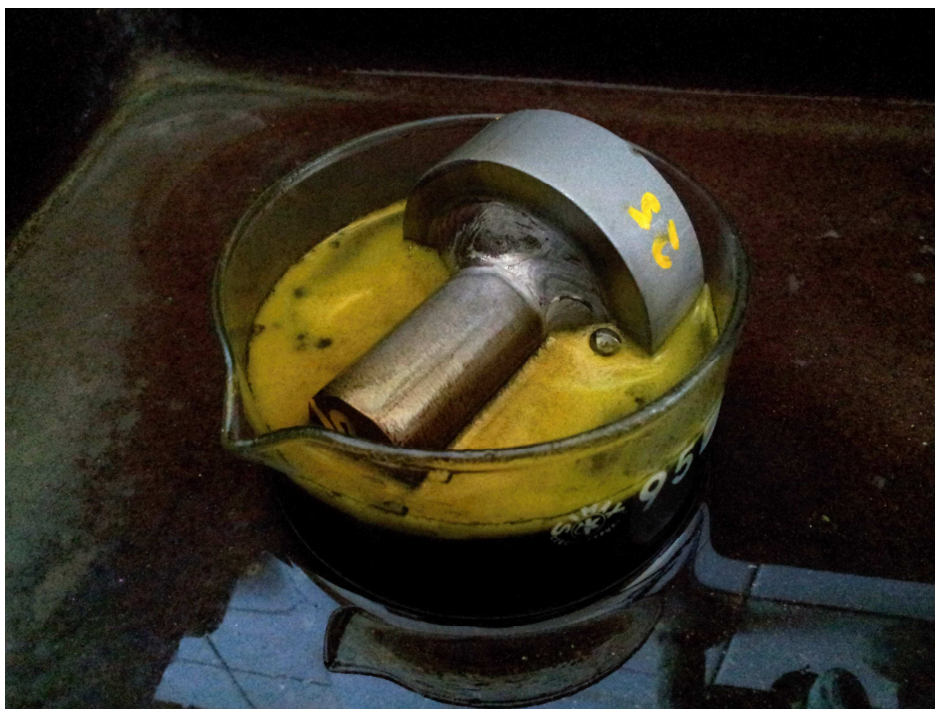
Obr.20 - Moření vzorku v mořící lázni s Inhibitorem P29
