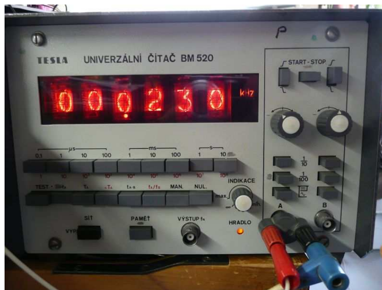
Obr. 4.5 naměřená frekvence 230Hz
