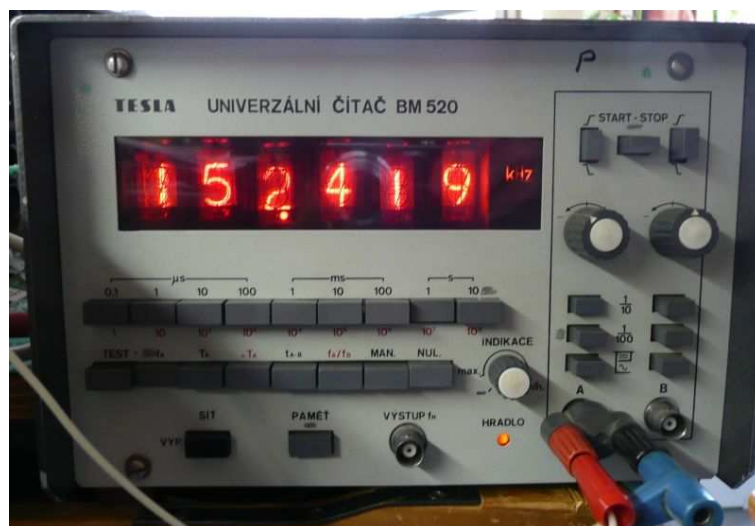
Obr. 4.7 naměřená nejvyšší frekvence 152,419kHz
