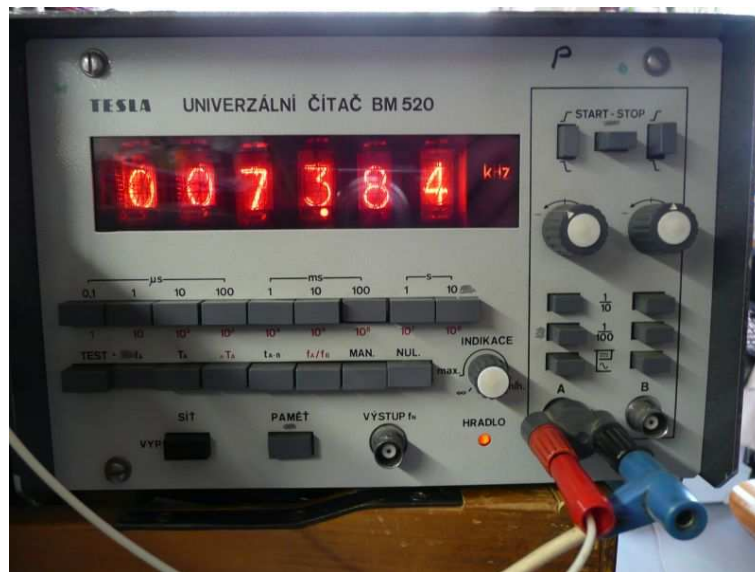
Obr. 4.6 naměřená frekvence 73,84kHz
