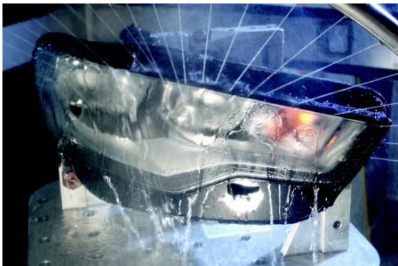
Obr. 8.1: Testování těsnosti světlometu pomocí trysek [18]
