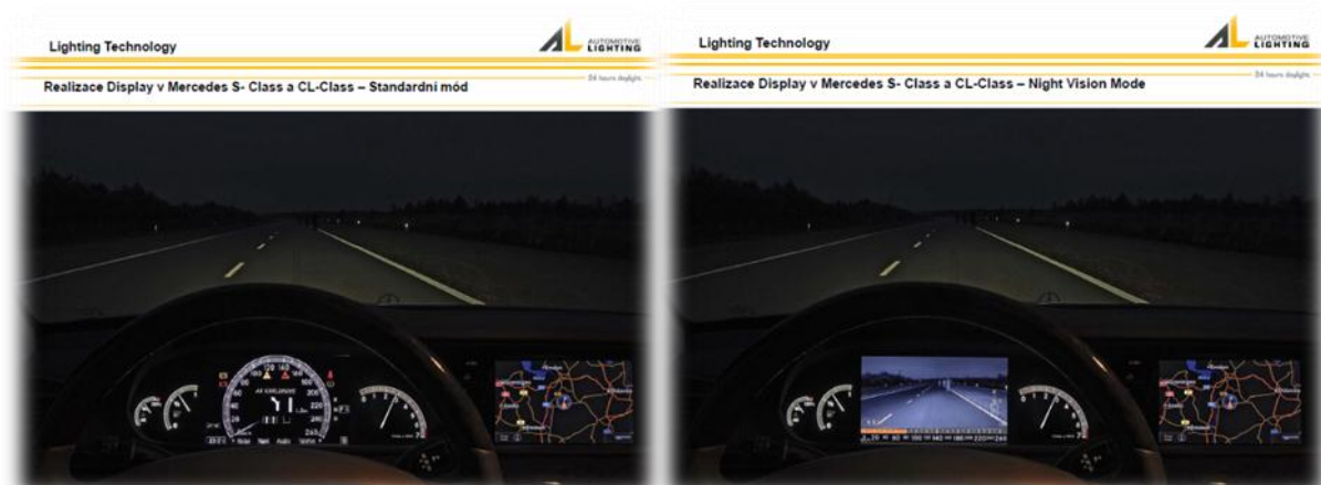
Obr. 6.7: Display: Standardní mód vs. Night Vision mód [41]
