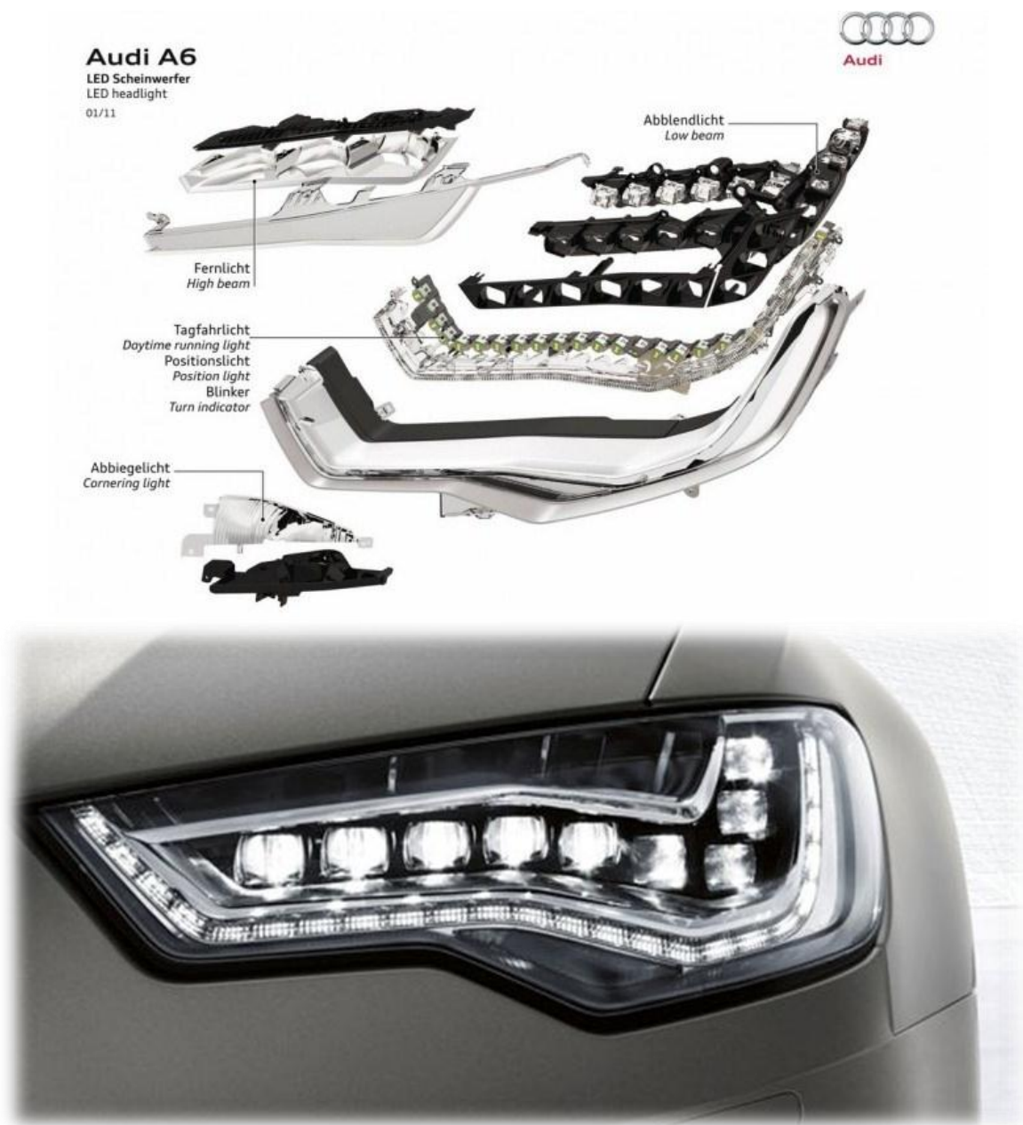
Obr. 6.3: Konstrukce světlometu Audi A6 [7][6]
