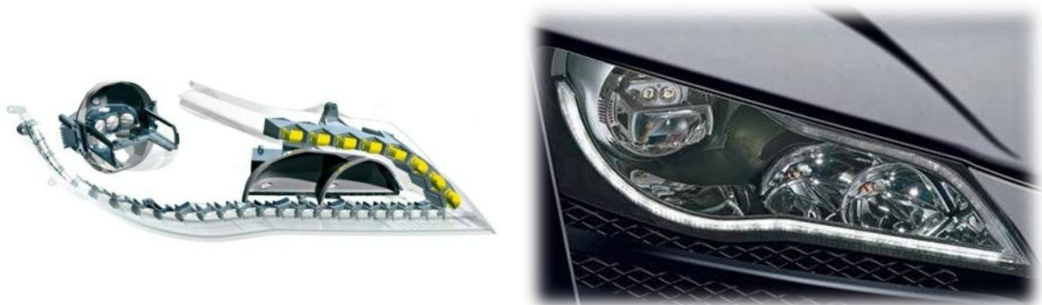
Obr. 6.4: Konstrukce světlometu Audi R8 [5] [34]
