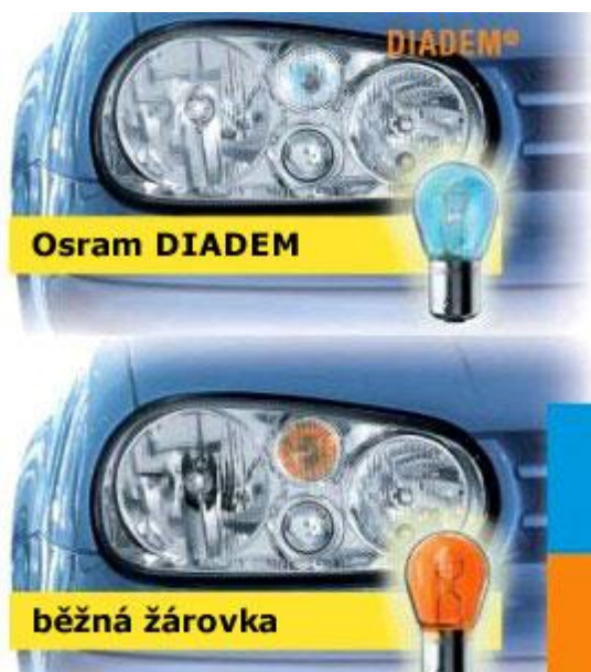
Obr. 2.3: Srovnání běžné a diadémové žárovky pro směrové světlo [14]
