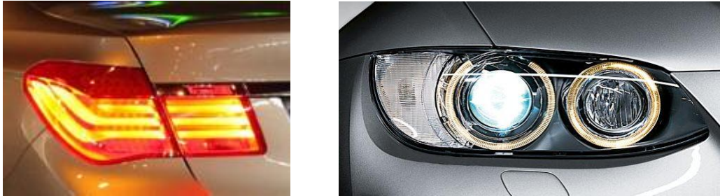
Obr. 6.5: Trojrozměrná světelná lišta BMW 7 [9] a světlovody pro denní svícení [11]
