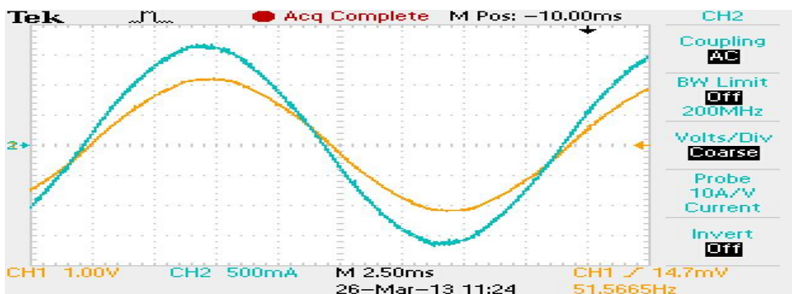
Obr.: 4.12. napětí a proud (napětí zobrazeno nižší amplitudou) [35]
