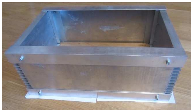
Obr. 17 – sestavená skříň bez komponent
