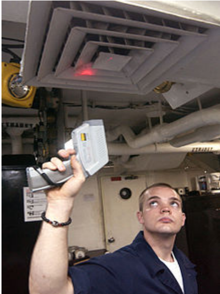
Obr. 26 Praktické snímání pyrometrem[21]
