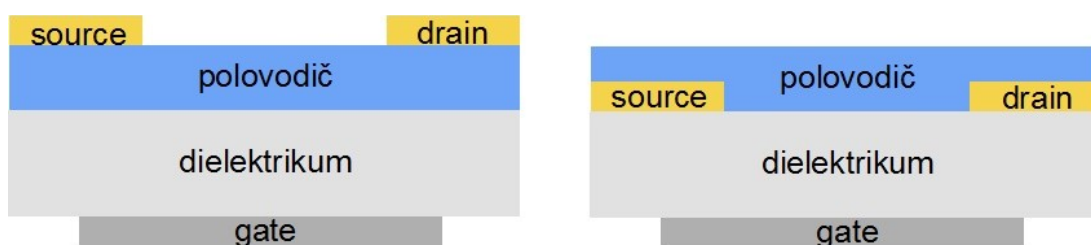
Obr. 13: Typické konfigurace OFET tranzistoru - top-contact, bottom contact 1
