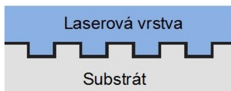
Obr. 11: Struktura organického polovodičového laseru s optickým rezonátorem 4
