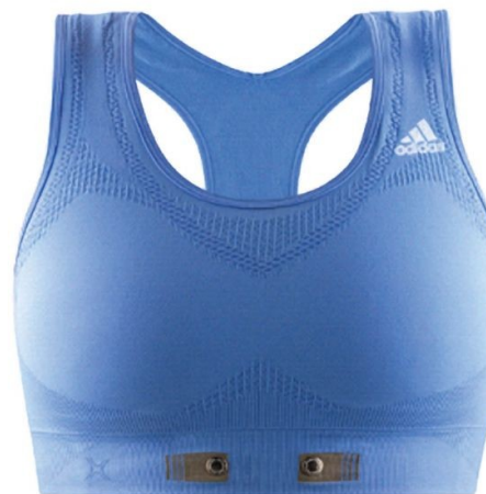
Obr. 16: Integrovaný snímač srdečního tepu do oblečení. © 2008 Textronics
