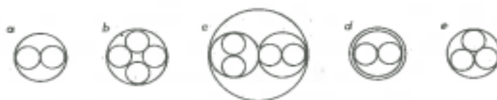
Obr. 2.5.2: Prvky souměrných kabelů, a – pár, b- křížová čtyřka, c – DM čtyřka, d - rozhlasový pár, e - trojka [1]
