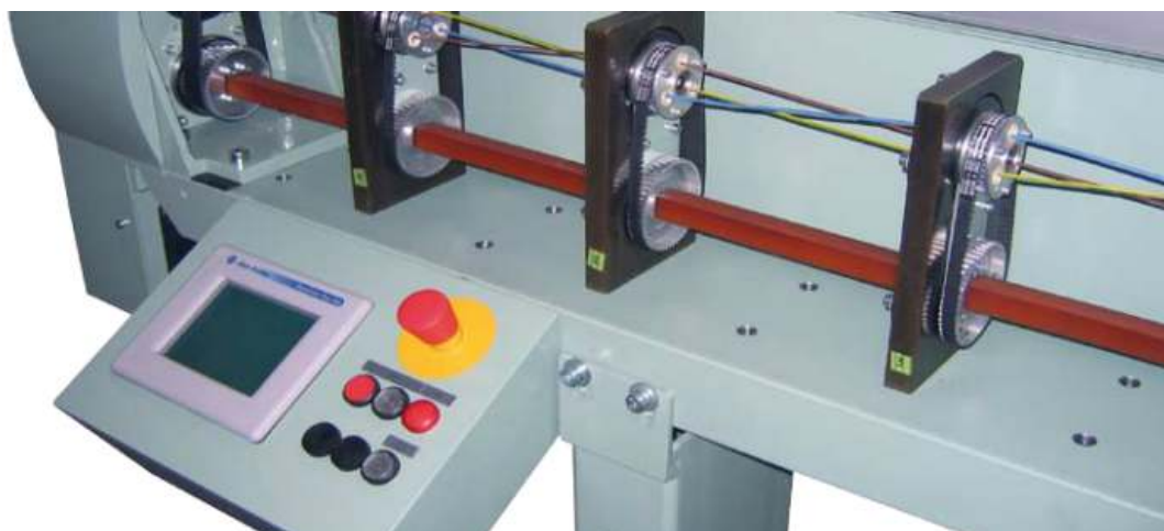
Obr. 2.5.4: Lanovací bod stáčecí linky DTSZ 45 [23]
