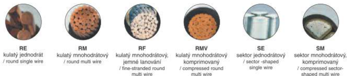
Obr. 2.1: Ukázka provedení elektrovodných jader [21]
