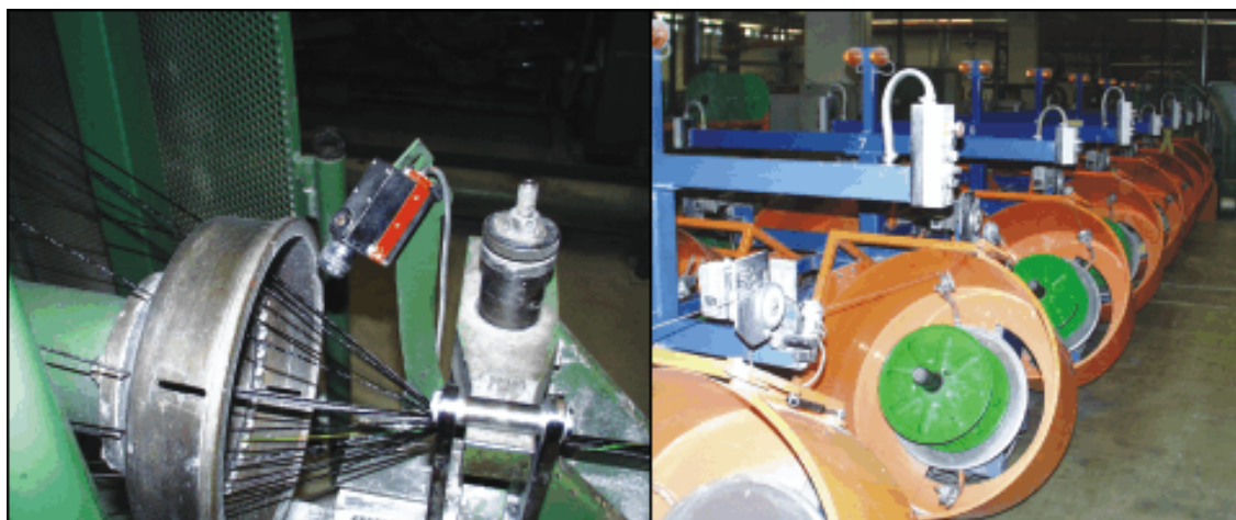
Obr. 2.5.3: Stáčení izolovaných žil s pravidelným zkrutem [10]
