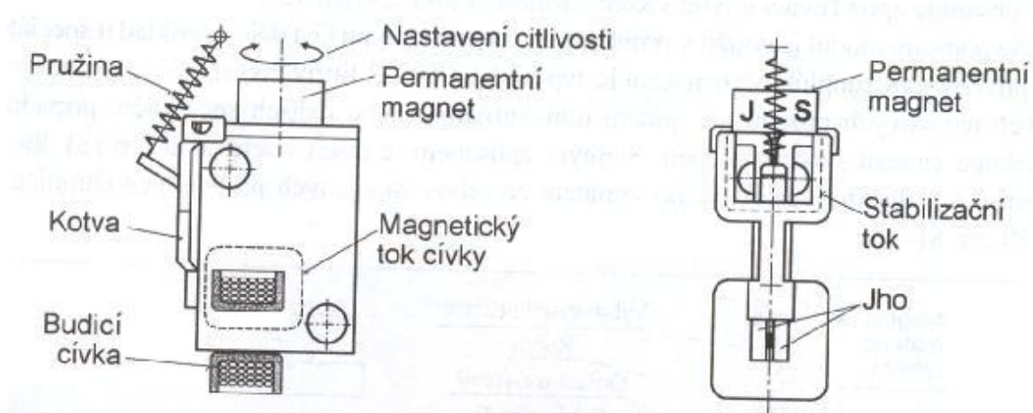
Obr. 2.5 Konstrukční provedení vybavovacího relé s permanentním magnetem s polarizovaným vybavováním – nejpoužívanější provedení [2]
