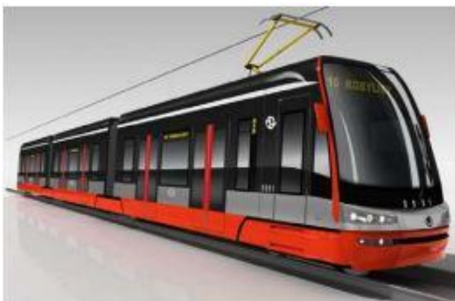
Obr. 43 Tramvaj 15 For City s trakčními PMSM, převzato z [13].
