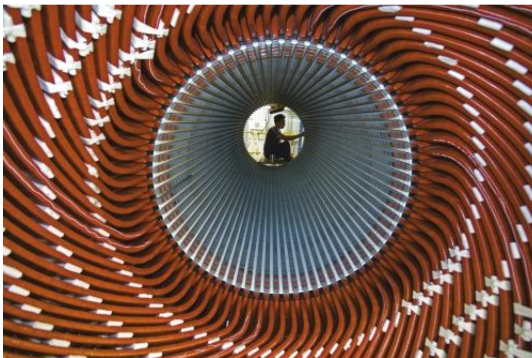
Obr. 29 Pohled do statoru turbogenerátoru, převzato z [19].
