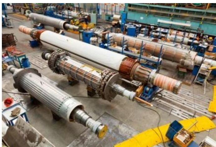
Obr. 45 Rotory turbogenerátorů vyrobené ve společnosti BRUSH SEM s.r.o., převzato z [14].
