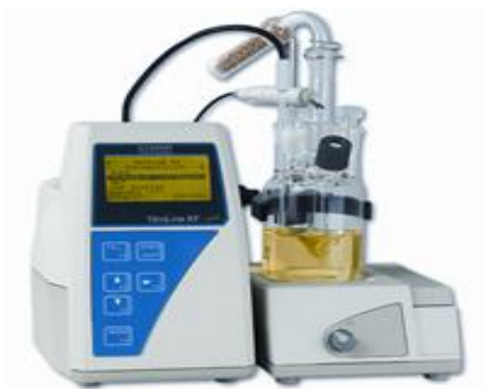
Obr. 0.2 Coulometrický titrátor Karl Fischer (převzato z [4])
