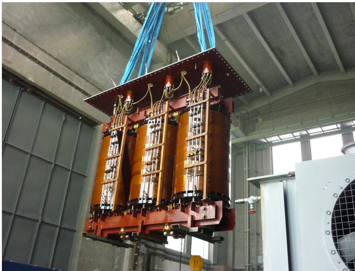
Obr. 2.17 Vytažení aktivní části 63BBT09
