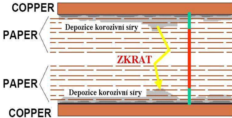
Obr. 1.4 Příčina zkratu způsobeného depozicí sulfidu mědného vzniklého z korozivní síry přítomné v izolačním oleji transformátoru (převzato z [10])
