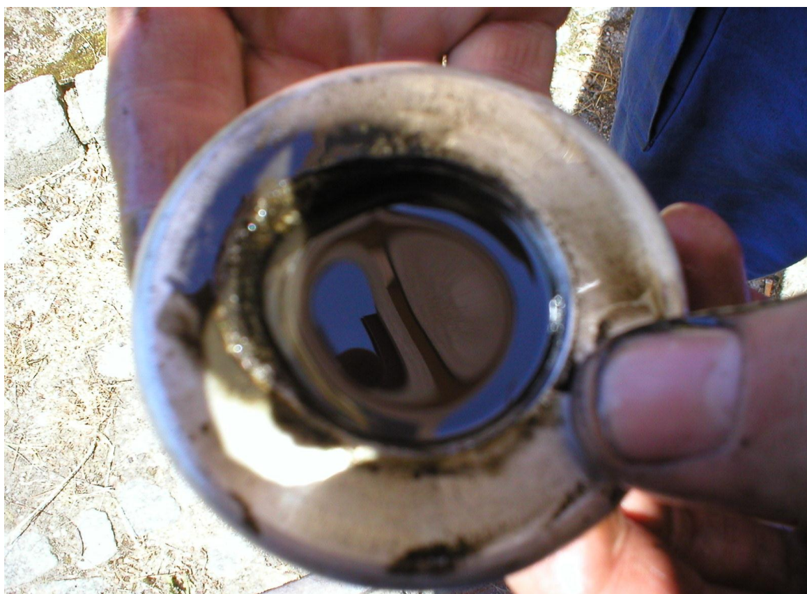
Obr. 2.7 Miska s černým spáleným olejem (převzato z [18])
