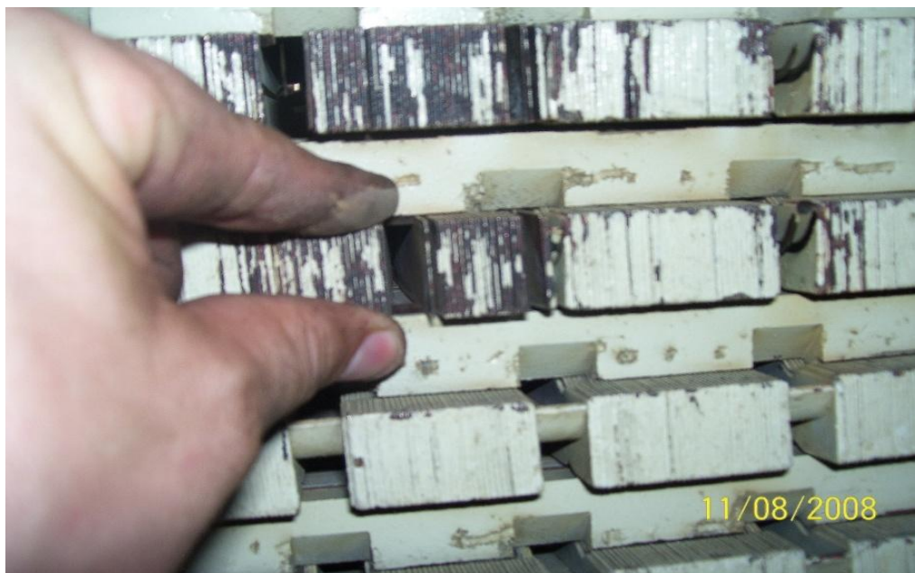
Obr. 3.3 TG2 - chybějící boční klíny, převzato z [24]
