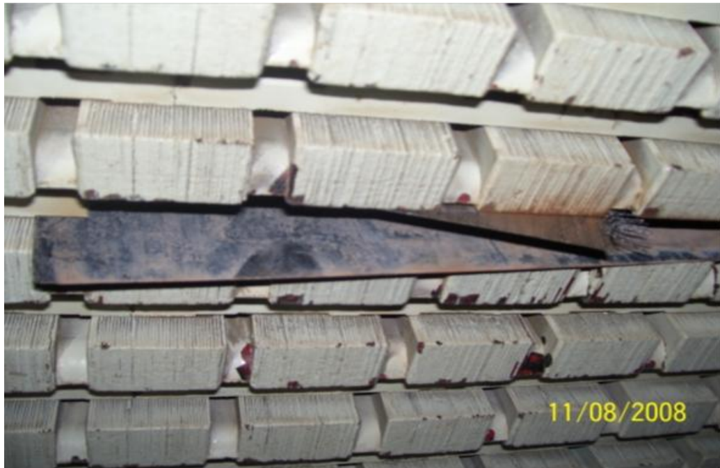
Obr. 3.4 TG2 – vypadané drážkové klíny, převzato z [24]
