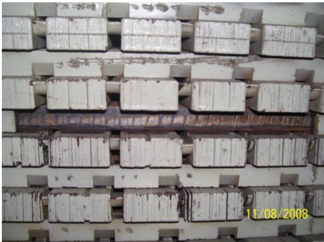
Obr. 3.5 TG2 – vypadané drážkové klíny, převzato z [24]
