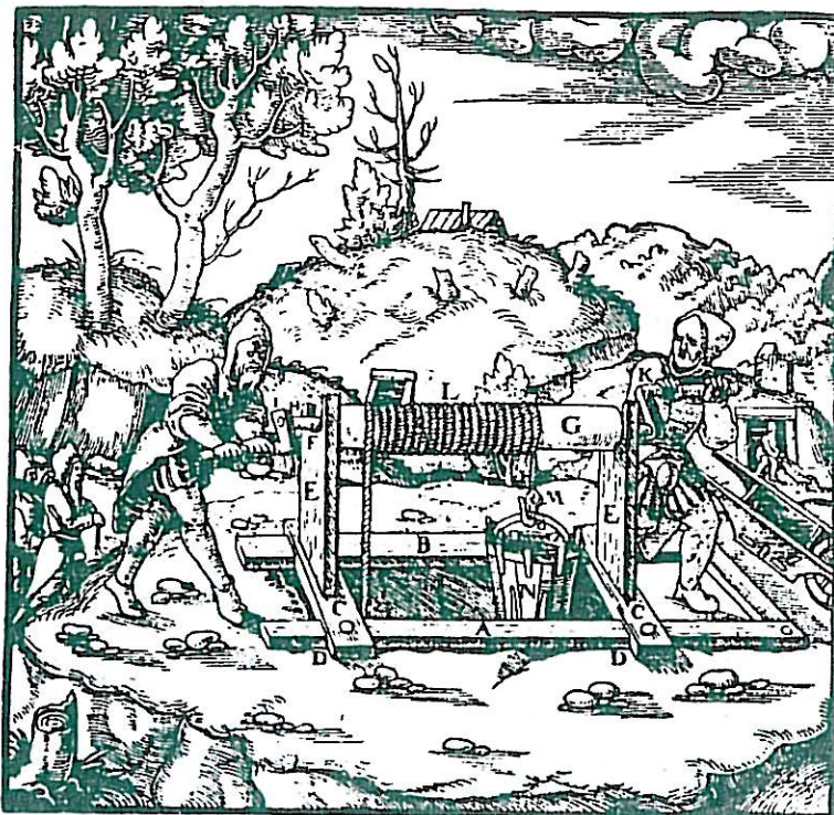
Přední dřevo věnce A. Zadní dřevo věnce B. Zašpičatělé koly C. Příčné trámce D. Vrátkové stojky E. Železná ložiska F. Válec G. Jeho čepy H. Dřevo I. Klíka K. Těžné lano L. Jeho hák M. Nádoba N. Její půlkruh O.
