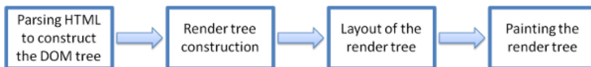
Obrázek 14: Schématický rozbor renderovacího procesu. (Zdroj: taligarsiel.com)
