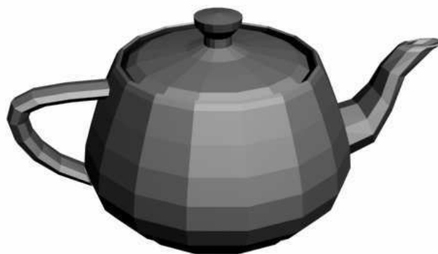
Obr. 4 : Povrchový model konvičky z polygonů zdroj [29]
