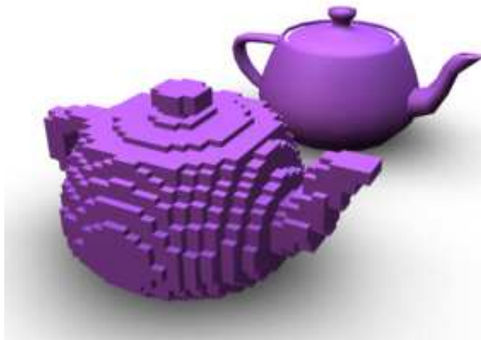
Obr. 6 : Princip objemové reprezentace pomocí voxelů (vlevo: voxelová konvička , vpravo: polygonální konvička) zdroj [18]
