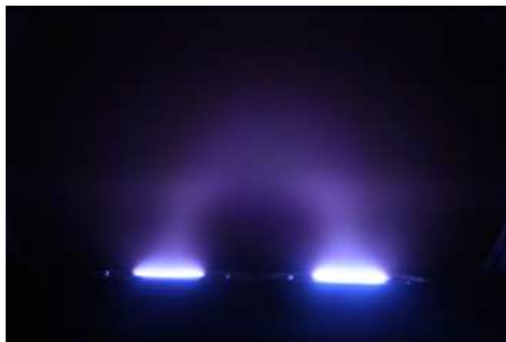
Obr. 4.3: Výboj plazmatu mezi magnetrony [31].
